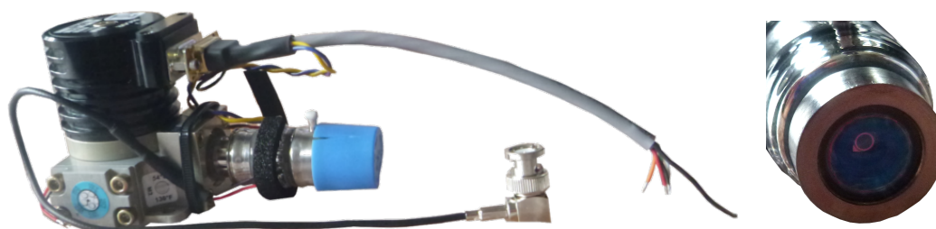
FIGURE 4.24 – Gauche : photographie du détecteur infrarouge et de son système de refroidissement, Droite : détail de la cellule sur le doigt froid.
