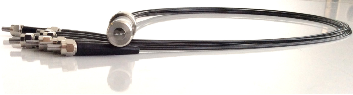
FIGURE 4.7 – Photographie du premier faisceau de fibre montrant les 8 fibres indépendantes, leur alignement en entrée et leurs connecteurs FC-FC en sortie. Cette image a été prise par Le Verre Fluoré, et leur sert actuellement d'exemple de fibres fabriquées sur plans.
