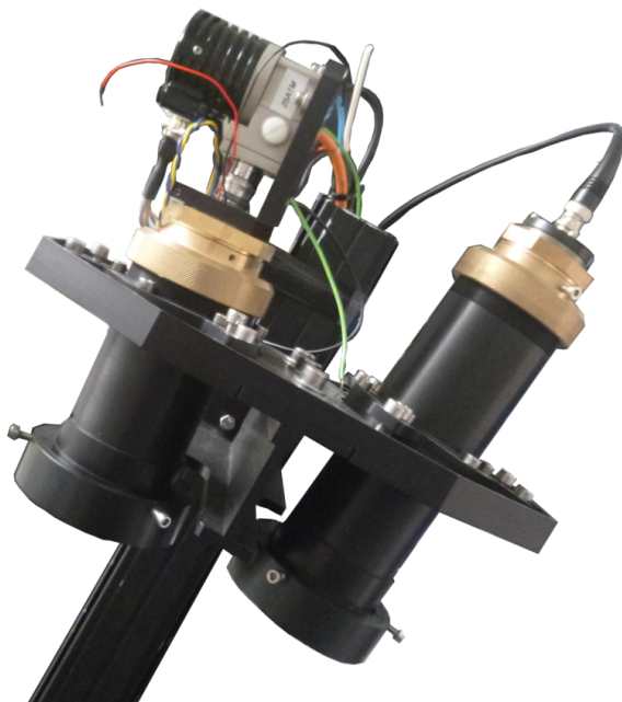
FIGURE 4.20 – Photographie des détecteurs montés sur le bras de mesure de SHADOWS.
