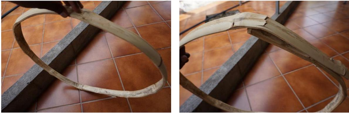
Figure 183 : Expérimentation d'une technique de fabrication utilisant le bambou pour la confection du cadre circulaire du *tambour malbar*. Saint-Pierre, 2017. Photos : SFP
