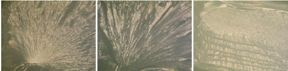
Figure 123. Images des profils de rupture pour une éprouvette imprimée (a) à 45° (b) horizontalement (c) verticalement
