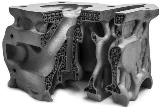
Figure 22. Concept de culasse de F1 réalisée sous LBM (Inovar Communications Ltd, 2016)
