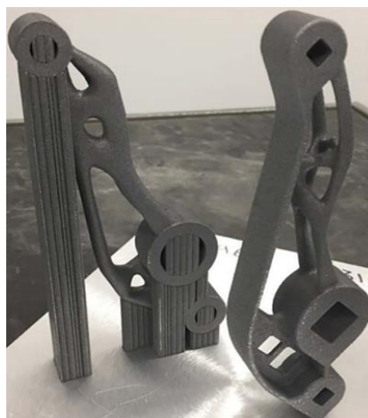
Figure 33. Comparaison entre la pièce obtenue par optimisation topologique (à gauche) et la pièce ayant subi en plus des modifications suivant les règles de tracé adaptées au procédé LBM pour diminuer les supports et le post traitement (à droite). (Saunders, 2017b)
