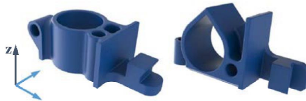
Figure 35. Impact du choix de l'orientation de la pièce sur sa conception l'axe z étant celui du dépôt de matière (Leutenecker-Twelsiek et al., 2016a)
