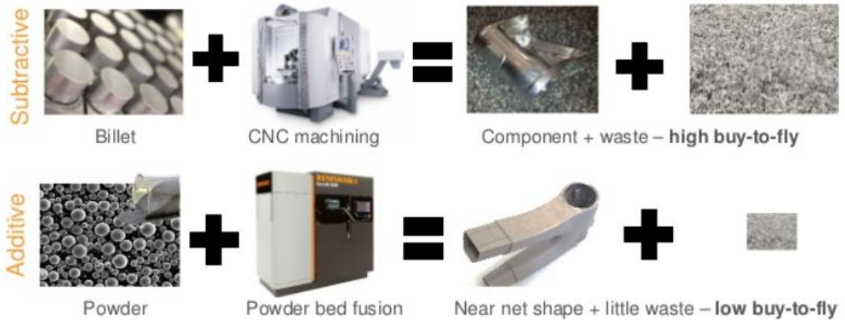
Figure 2. Différence entre usinage et fabrication additive. Source: Renishaw.com
