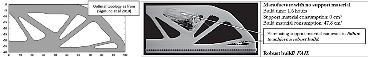
Figure 28. Défaut de réalisation d'une surface en surplomb réalisée par FDM sans support (Leary et al., 2014)
