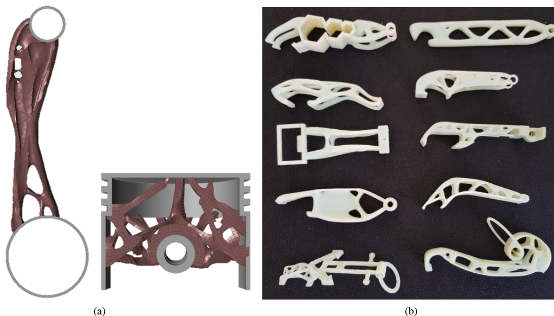
Figure 108. (a) Projet d'optimisation d'un système bielle manivelle réalisé par les étudiants de l'école d'ingénieurs SeaTech en appliquant la méthode TOMS pour la LBM ; (b) Travaux de conception optimisée d'un décapsuleur à réaliser par FA
