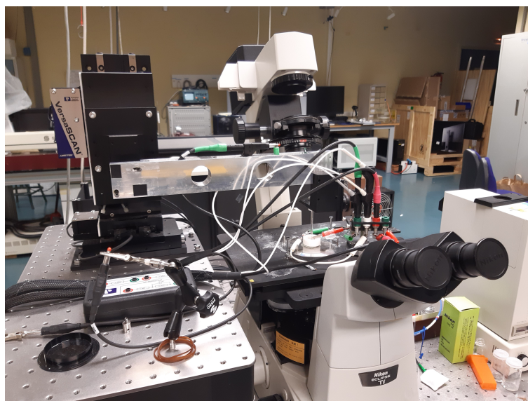
FIGURE 4.4 – Photo du dispositif couplant microscope électrochimique à balayage avec microscope de fluorescence. Le bras mécanique permet de positionner l'UME au-dessus de la platine du microscope optique. Il est relié au dispositif piezoélectrique.
