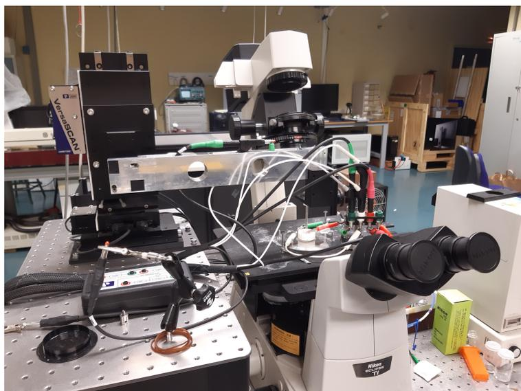
FIGURE 4.4 – Photo du dispositif couplant microscope électrochimique à balayage avec microscope de fluorescence. Le bras mécanique permet de positionner l'UME au-dessus de la platine du microscope optique. Il est relié au dispositif piezoélectrique.
