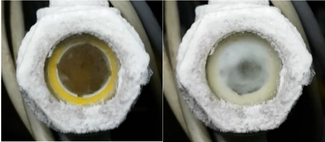
Figure 88 Photographie du regard en sortie d'évaporateur lors du fonctionnement de l'unité avec à gauche le fluide pur et à droite une mousse
