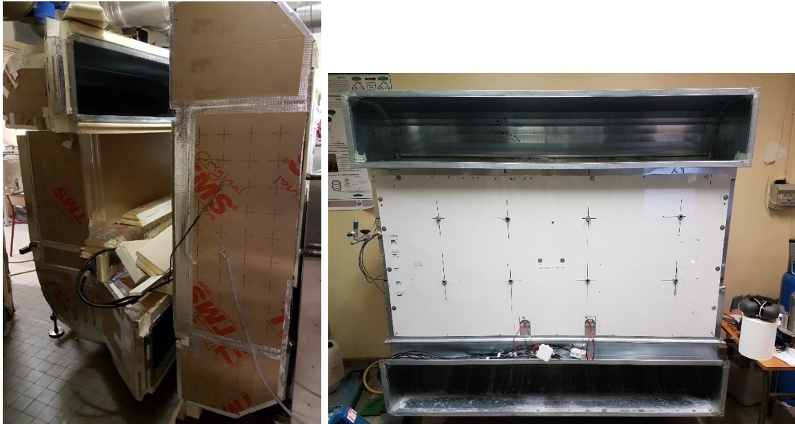
Figure 34 Caisson isolé dans la salle d'essais
