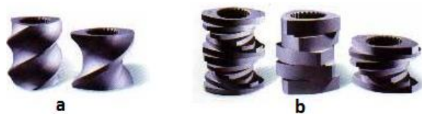
Figure 64 : Eléments pour extrudeuse bi-vis a) éléments hélicoïdaux b) éléments malaxeurs
