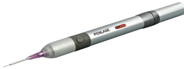
Figure 1.13 : Dispositif portatif pour chirurgie dentaire (diode laser 800 nm, 2W de sortie) avec plusieurs applications y compris l'ablation thermique des abcès et l'hémostase.
