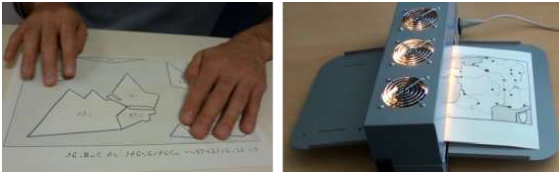
Figure 1. À gauche : une personne lisant un planisphère en relief ; à droite : l'impression d'une carte en relief.
