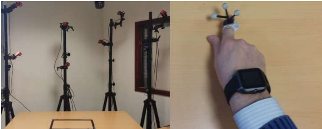
Figure 59. À gauche : configuration expérimentale avec les caméras ; à droite : marqueurs sur le doigt.
