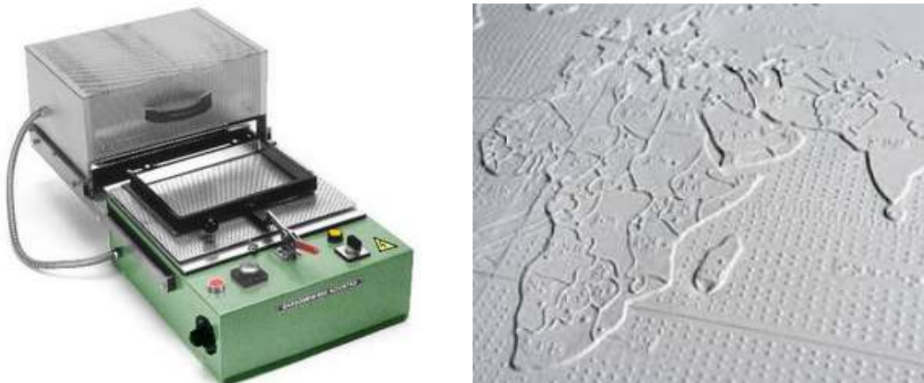
Figure 8. À gauche : Une thermoformeuse ; à droite : le document résultant.
