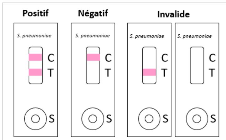
**Figure 30. Les différents résultats possibles du test PneumoSpeed.**
