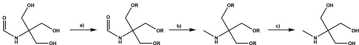
Figure 1.45 : nouvelle stratégie envisagée pour la réduction du composé 17 ; a) protection des fonctions alcool, b) réduction du formamide et c) déprotection des hydroxyles.
