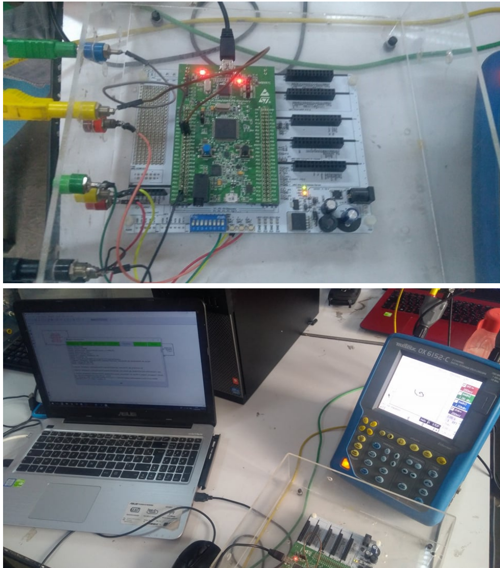
FIGURE 3.19 – Validation expérimentale du système proie-prédateur à l'aide de la technologie STM
