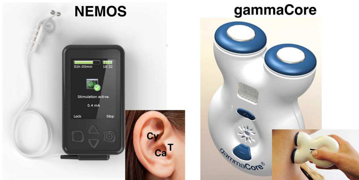
Figure 50. Les dispositifs de neurostimulation vagale transcutanée. Le modèle NEMOS et le modèle gammaCore. D'après Yuan et Silberstein, 2016. 334
