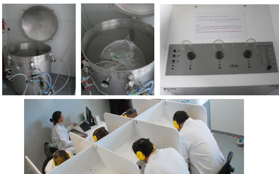
Figure 8 : Olfactomètre à dilution dynamique (ODILE®)
