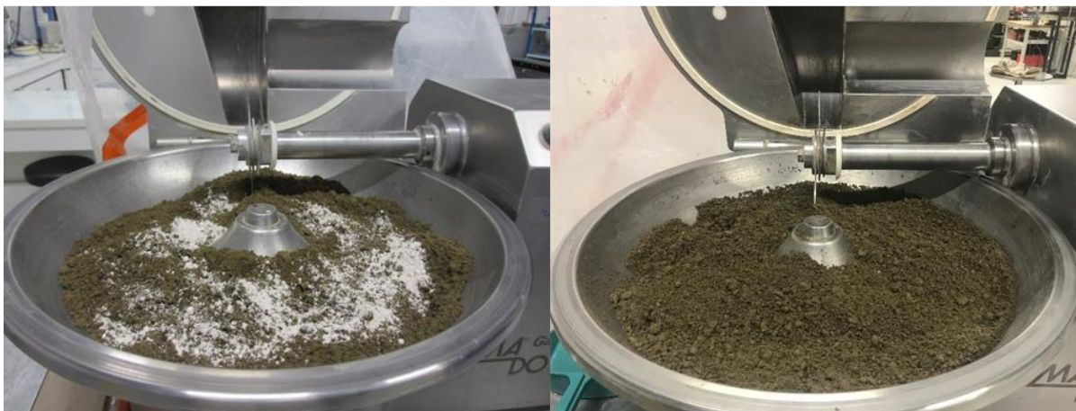
Figure II.7 : A gauche, épandage de la chaux sur le sol dans le malaxeur ; A droite, aspect du matériau après le malaxage.
