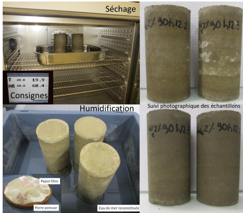
Figure II.10 : Illustration des conditions de séchage et d'humidification des éprouvettes. Un suivi photographique des éprouvettes est effectué à la fin de chaque phase pour contrôler visuellement l'homogénéité des éprouvettes, et notamment à leurs extrémités.
