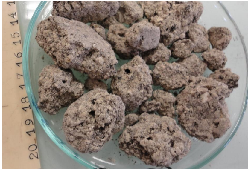
Figure 23 : Agrégats du traitement « vers de terre ». Les macropores (galeries) sont visibles à l'œil nu après séchage à l'air libre pendant 3 h.
