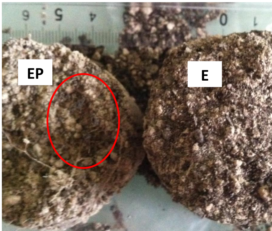
Figure 24 : Comparaison des traitements « vers de terre + plantes » et « vers de terre » après saturation pendant une semaine puis application de la mesure de courbe de retrait. On voit à l'œil nu la galerie d'un ver de terre dans le traitement EP, alors que rien n'est visible sur le traitement E.
