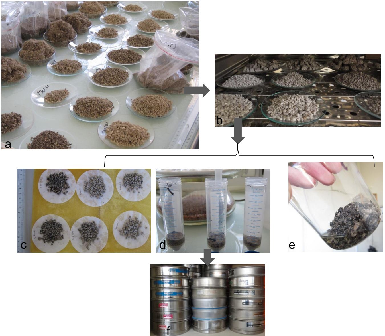
Figure 12 : Différentes étapes de la mesure de la stabilité structurale : (a) tamisage entre 3 et 5 mm, (b) séchage en étuve à 40 °C, (c) humectation lente, (d) rapide, (e) agitation mécanique et (f) passage dans six tamis.
