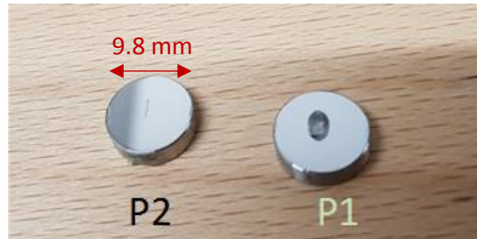
Figure xviii : Echantillons HFRR 40°C condition extrême
