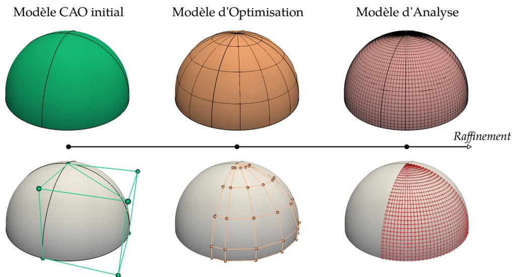
**Figure A.2** – Optimisation de forme dans le cadre de l'IGA ; l'optimisation peut s'effectuer sur le modèle CAO initial, sur le modèle fin d'analyse, ou pour des niveaux de raffinement intermédiaires.
