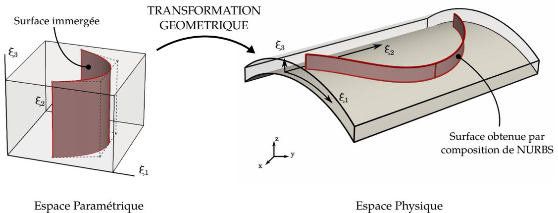
**Figure A.8** – Construction d’une structure raidie en utilisant les surfaces immergées. La surface finale décrivant le raidisseur est obtenu pour la composition d’une surface NURBS et d’un volume NURBS. Cette construction garantit que le raidisseur repose parfaitement sur la portion de cylindre.
