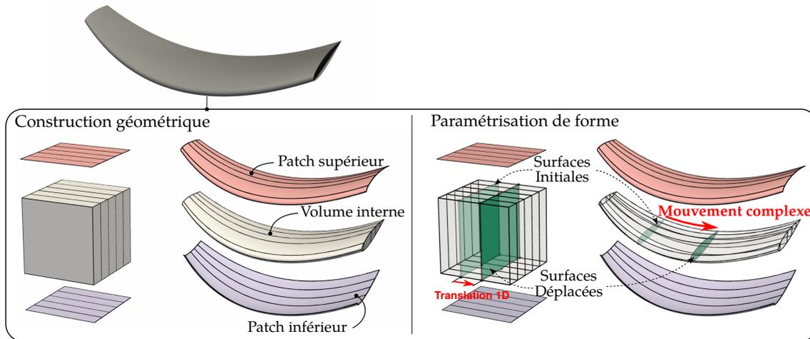
**Figure A.12** – Construction et paramétrisation de forme de la structure interne d’une aile. Un volume est généré à partir de deux surfaces représentant la géométrie extérieure de l’aile. Il est alors possible d’immerger et de déplacer des surfaces dans l’espace paramétrique du volume pour construire la structure interne.
