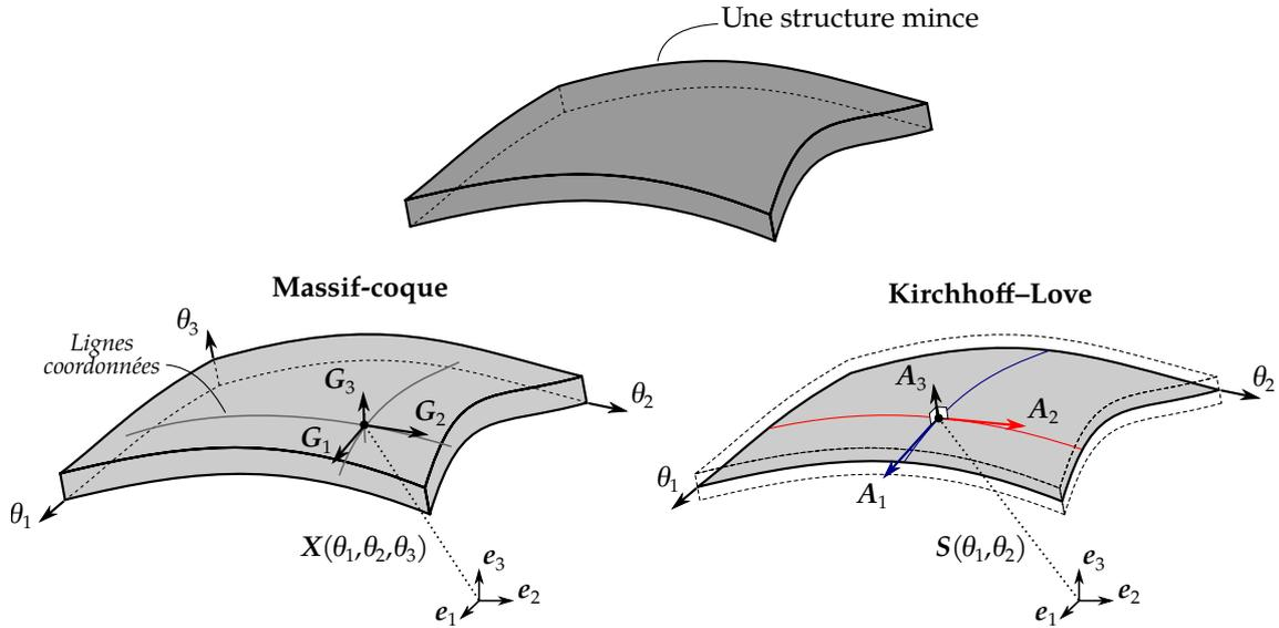
**Figure A.3** – Deux approches pour le calcul de coques : l’approche massif-coque où la structure est entièrement représentée et l’approche Kirchhoff-Love où seulement la structure est décrite à partir de la surface moyenne uniquement.
