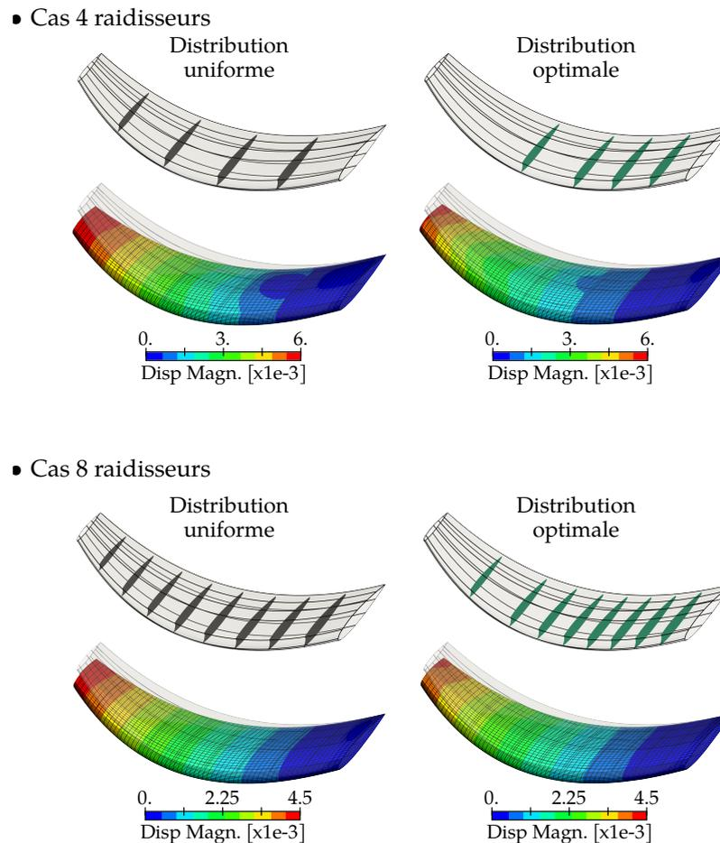
**Figure A.13** – Optimisation de la structure interne d’une aile : distribution optimale de 4 et de 8 raidisseurs la long de l’aile. Un meilleur positionnement des raidisseurs rigidifie l’ensemble de la structure.
