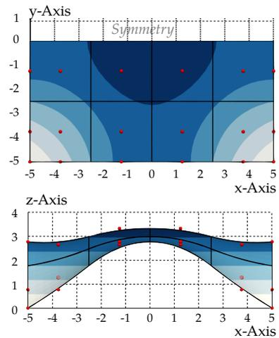
**Step 2. Optimisation détaillée de l'épaisseur à l'aide des éléments massifs coques**
