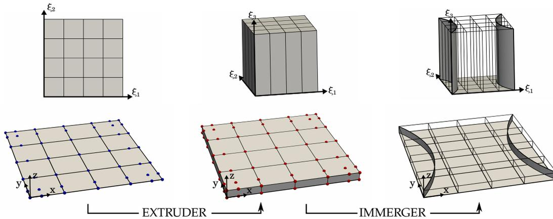
**Figure A.10** – Construction de la géométrie du toit raidi : à partir d’une plaque plane, un volume est généré par extrusion puis deux surfaces sont immergées dans l’espace paramétrique (en haut) de ce volume. Les deux raidisseurs dans l’espace physique (en bas) sont alors obtenus par composition.
