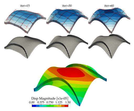
**Figure A.11** – Résultats pour le problème du toit muni de deux raidisseurs. A gauche, modification de la forme imposée par le mouvement vertical des points de contrôle du volume (points rouges). Le champ de couleurs quantifie cette variation de forme. A droite, le modèle d'analyse de la géométrie finale.
