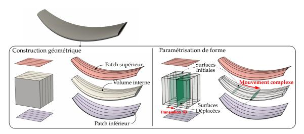
**Figure A.12** – Construction et paramétrisation de forme de la structure interne d'une aile. Un volume est généré à partir de deux surfaces représentant la géométrie extérieure de l'aile. Il est alors possible d'immerger et de déplacer des surfaces dans l'espace paramétrique du volume pour construire la structure interne.
