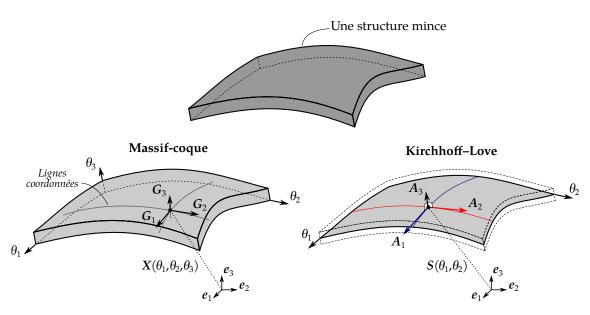
Figure A.3 – Deux approches pour le calcul de coques : l'approche massif-coque où la structure est entièrement représenté et l'approche Kirchhoff–Love où seulement structure est décrite à partir de la surface moyenne uniquement.
