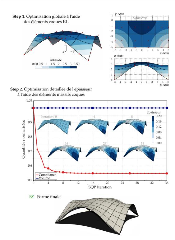
**Figure A.4** – Approche mutli-modèle : dans une première phase de conception, une formulation coque type Kirchhoff–Love permet d'optimiser la forme globale de la structure. De cette première étape, un modèle volumique est généré afin de représenter explicitement toute la structure. Ensuite, l'approche basée sur les éléments massifs coques permet d'optimiser la carte d'épaisseur jusqu'à obtenir la géométrie finale.
