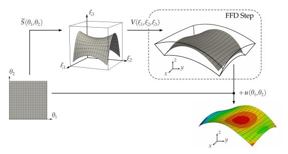
**Figure A.9** – Formulation Kirchhoff–Love immergée. Le champ des déplacements est approché par la même paramétrisation que la surface immergée  $\bar{\mathbf{S}}$ . Cependant cette surface ne décrit pas la géométrie de la coque mais une transformation volumique supplémentaire est appliquée. La configuration déformée est obtenue en additionnant le champ des déplacements à la composition de NURBS.
