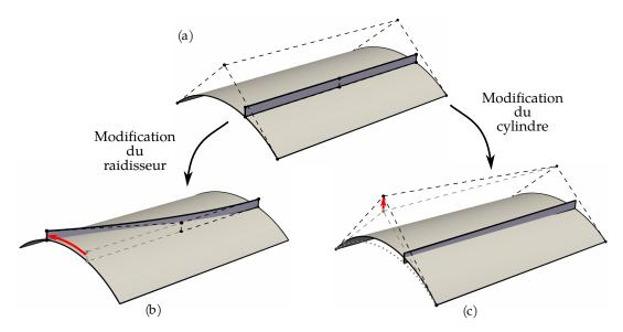
**Figure A.7** – Portion de cylindre avec un raidisseur : (a) deux surfaces NURBS permettent de décrire cette géométrie. Cependant le paramétrage de la forme est délicat : (b) modifier la position des points de contrôle du raidisseur ou (c) ceux du cylindre déconnecte les deux pièces.
