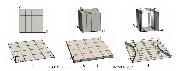
**Figure A.10** – Construction de la géométrie du toit raidi : à partir d'une plaque plane, un volume est généré par extrusion puis deux surfaces sont immergées dans l'espace paramétrique (en haut) de ce volume. Les deux raidisseurs dans l'espace physique (en bas) sont alors obtenus par composition.
