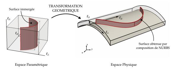
**Figure A.8** – Construction d'une structure raidie en utilisant les surfaces immergées. La surface finale décrivant le raidisseur est obtenu pour la composition d'une surface NURBS et d'un volume NURBS. Cette construction garantit que le raidisseur repose parfaitement sur la portion de cylindre.
