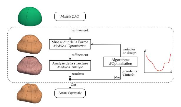
**Figure A.1** – Fonctionnement de l'optimisation de forme dans le cadre de l'IGA; visualisation des étapes principales.
