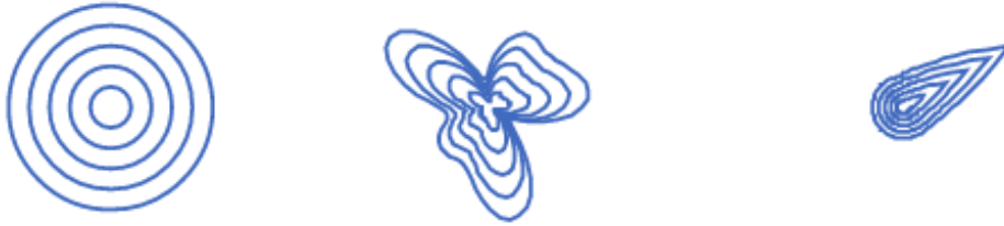
FIGURE 3.10 – Illustration des différents types de fronts de propagation qui peuvent être obtenus avec les différents algorithmes, de gauche à droite : Breadth first Search, Dijkstra et A* [noa]. Le point de départ est au centre de la zone et la cible en haut à gauche.
