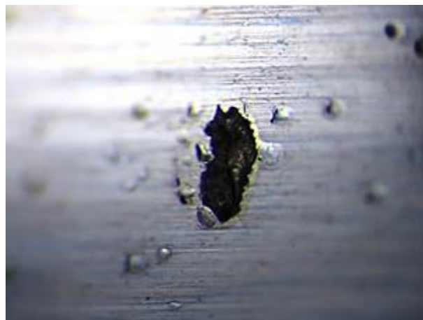
Figure 1-17: Micro-écaille sur un roulement - Image NTN-SNR
