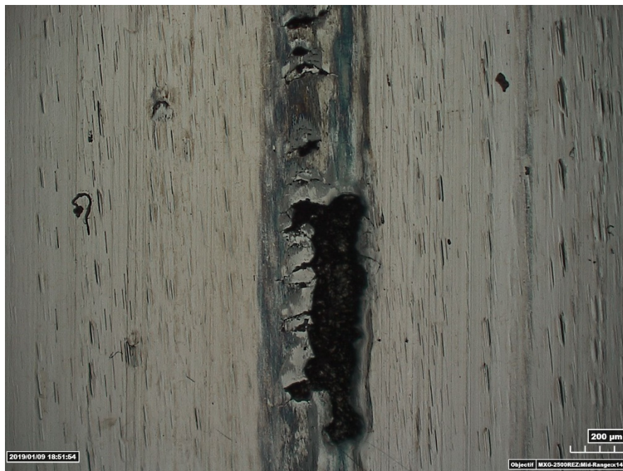
Figure 4-37: Observation de la piste de contact après huit d'heures d'initiation pour un galet de nitration a
