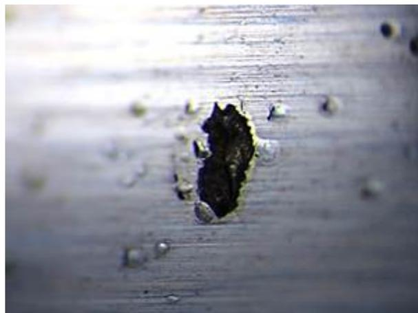
Figure 1-17: Micro-écaille sur un roulement - Image NTN-SNR
