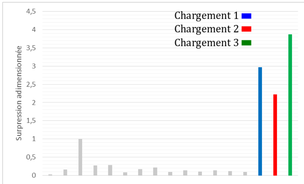
Figure 3-14 : Surpressions adimensionnée des chargements comparées à celles des états de surfaces des partenaires.
