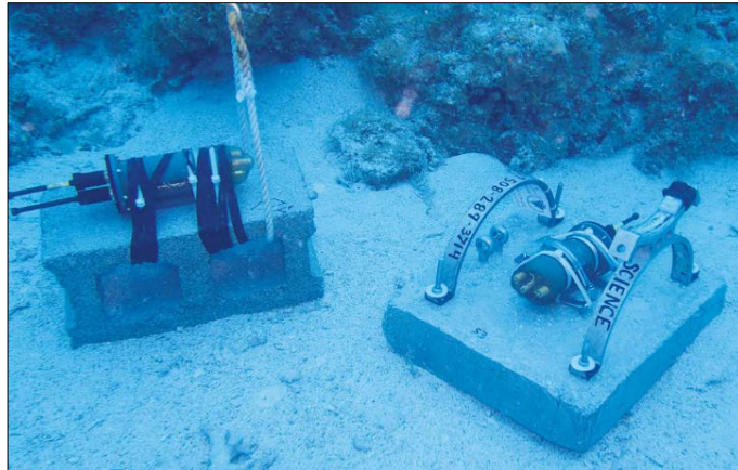
Figure 2.6. Enregistreurs déployés par Kaplan et al. (2015) dans les îles vierges US.
