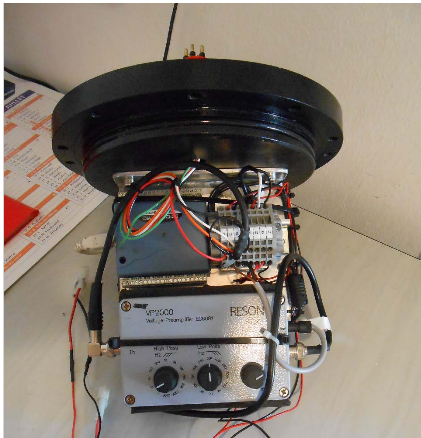
Figure 2.5. Un des deux enregistreurs acoustiques utilisés pour les déploiements ponctuels de cette étude. La carte d'acquisition et le préamplificateur sont visibles, le PC se situe derrière ces deux composants
