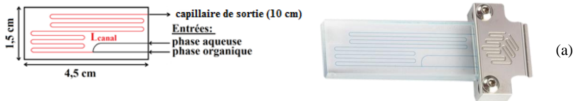
Figure V-1(a) : Schéma et photographie du microsysteme à jonction en T hydrophobe utilisé pour l'étude de l'extraction réactive du système chimique \text{Eu}/\text{HNO}_3/\text{DMDBDTMA} , longueur de micro-canal de sortie = 27,8 cm
