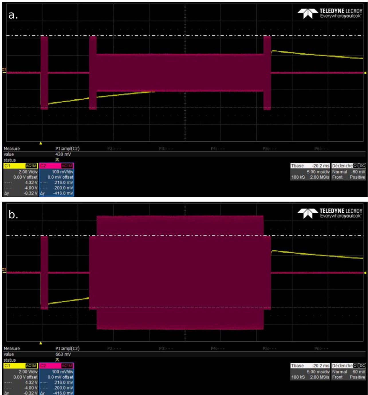
FIGURE 9.2 – Signal réel transmis par l’antenne pour deux intensités de SL différentes. Paramètre de la séquence MSE de spectroscopie : TE = 34,5 ms, RF de \frac{\pi}{2} : bp, Intensité : 5,8 \mu T , durée 1 ms, RF de saturation : bino1, Intensité : 3,04 \mu T (a) et 8,5 \mu T (b), durée : 23 ms.
