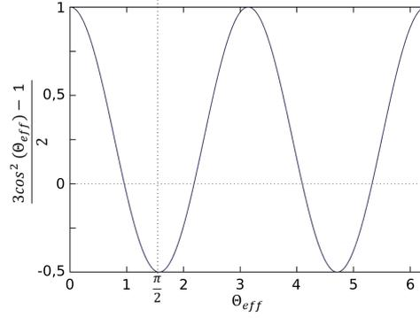
FIGURE 4.2 – Comportement de la constante dipolaire en fonction de l’angle  $\Theta_{eff}$  du champ efficace par rapport au champ principal  $B_0$ .
