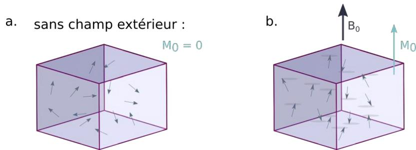
FIGURE 1.1 – **Action d'un champ magnétique  $B_0$  sur un échantillon.** Le champ magnétique extérieur  $B_0$ , oriente les aimantations microscopiques initialement réparties de manière homogènes (a.), autour d'un seul axe (b.).
