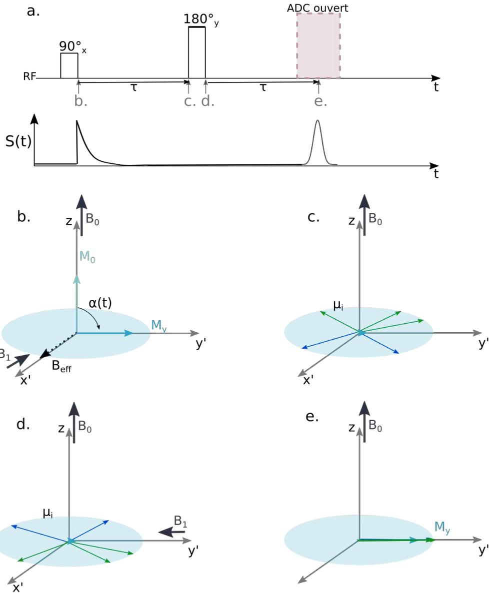
FIGURE 1.10 – **Détail d’une séquence théorique d’écho de spin.** Par soucis de simplification aucun gradient n’est pris en compte ici. a. chronogramme. b.-c. comportement des aimantations similaire au cas de la figure 1.5. d. Les aimantations basculent de  $\pi$  rad autour de  $y$  sous l’effet de  $B_1$ . e. Les aimantations microscopiques ont évoluée librement pendant  $\tau$ , donc l’aimantation macroscopique dans le plan transverse n’est plus nulle et vaut  $M_0$ .
