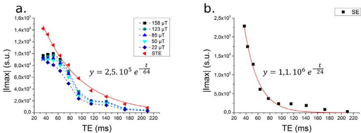
FIGURE 8.3 – **Etude de la relaxation sur le plastisol.** A partir des résultats de la décroissance du signal obtenu avec la séquence spectroscopique utilisant une binomiale 1 (a) et la CPMG (b) sur le fantôme de plastisol 75% standard, pour différents TE.
