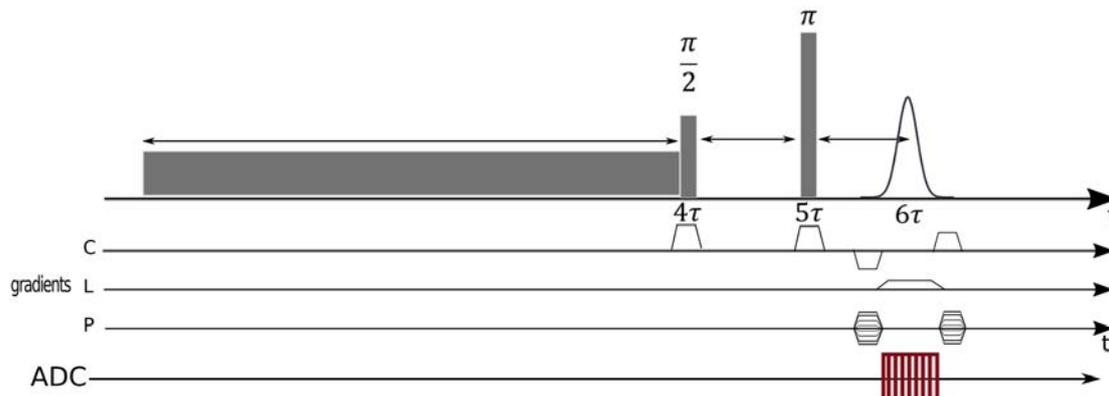
FIGURE 9.1 – **Séquence dipolaire « inversée » pour l'imagerie.** Elle est constituée d'un module de préparation sous la forme d'une impulsion de saturation suivi d'un module d'excitation sous la forme d'une séquence d'écho de spin.
