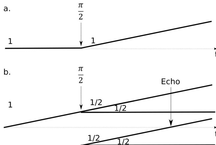
FIGURE 5 – Diagramme de déphasage pour une RF de  $\frac{\pi}{2}$  appliquée sur des aimantations initialement suivant z (a.) et initialement dans le plan transversal (b.). Sur la figure b, un écho d'intensité  $\frac{1}{2}$ , se formerait là où le chemin de déphasage coupe l'axe des temps sur le graphique, ce qui correspond à un rephasage des aimantations.
