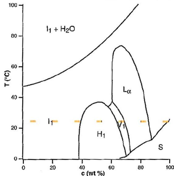
FIG. 1.1 – Diagramme de phases du mélange  $C_{12}EO_6/H_2O$ .
