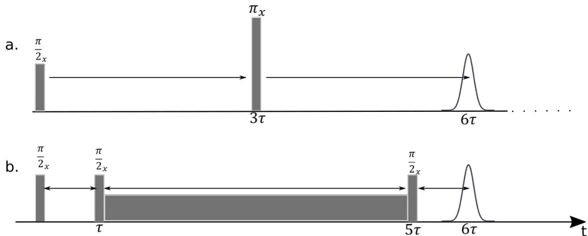
FIGURE 4.11 – **Chronogramme de la séquence de contraste dipolaire du laboratoire.** Elle correspond à l'exécution d'une séquence d'écho de spin (b.) suivie d'une séquence MSE (a.). Les séquences sont implémentées pour que les échos dans les deux séquences se produisent à  $6\tau$ , avec un  $\tau$  identique pour chaque séquence.
