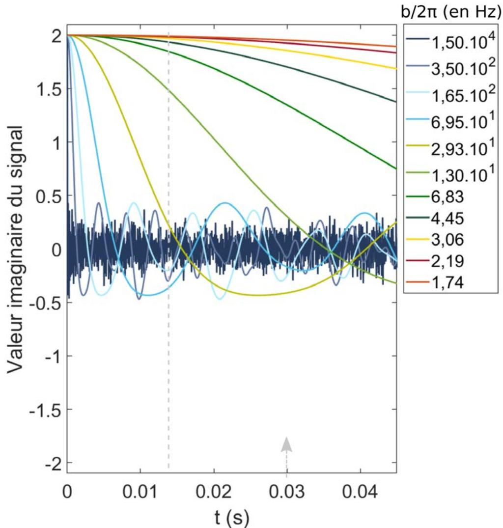
FIGURE 4.8 – Résultats de simulation d'une séquence d'écho de spin avec **uniquement l'effet de l'interaction dipolaire**. Le signal tracé est toujours mesuré dans le plan transversal, chaque moment où une impulsion est appliquée est indiqué par des pointillés. La flèche en bas du graphique indique la position de l'écho prédit par la théorie dans le cas où toutes les interactions s'exprimeraient, et non comme dans le cas particulier représenté ici.
