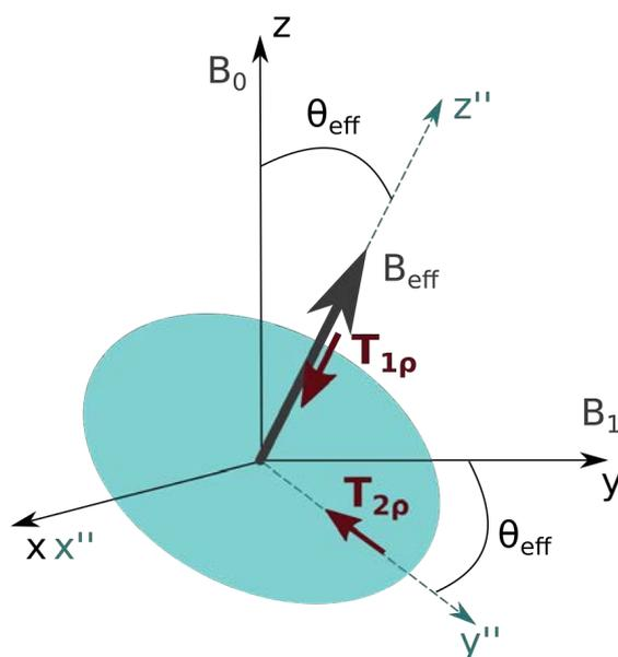
FIGURE 4.14 – Processus de relaxations apparaissant dans le double repère tournant sous l'effet d'une RF. Dans le cas particulier d'une RF de saturation d'intensité suffisante, le champ  $B_{eff}$  est appliqué suivant  $x'$  du double repère tournant sur ce schéma. (Schéma inspiré de S. Michaeli et al., Transverse relaxation in the rotating frame induced by chemical exchange, Journal of Magnetic Resonance 169 (2004) 293-299)
