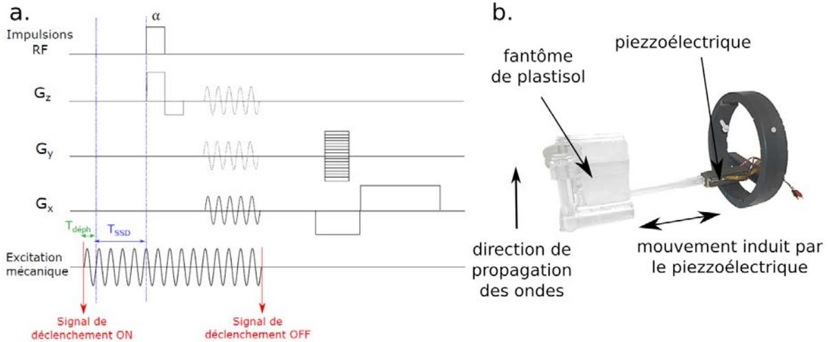
FIGURE 5.5 – Séquence RARE-ERM et dispositif d’excitation d’élastographie par résonance magnétique. a. Schéma d’écho de gradient utilisé pour acquérir les images d’ERM (extrait de la thèse de P. Lefebvre [65] p.137.). b. Dispositif utilisé pour réaliser les acquisitions d’ERM sur les fantômes de plastisol.
