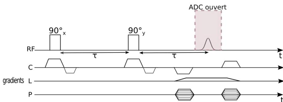
FIGURE 1.9 – **Chronogramme d'une séquence théorique d'écho solide implémentée pour l'imagerie avec gradient de lecture**, avec un encodage cartésien. L'écho peut être acquis dans des zones où le gradient est constant, cela simplifie l'encodage de la transformée de Fourier et la reconstruction du signal.
