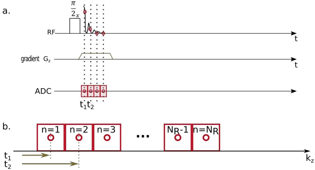
FIGURE 1.3 – Acquisition du signal avec un gradient de lecture après une impulsion de  $\frac{\pi}{2}$  suivant  $x$  (a.). A chaque intervalle de temps un nouveau point est acquis (b.), l'aire sous la courbe du gradient correspond à un déphasage de l'aimantation, qui est codé dans l'espace des  $k$ .
