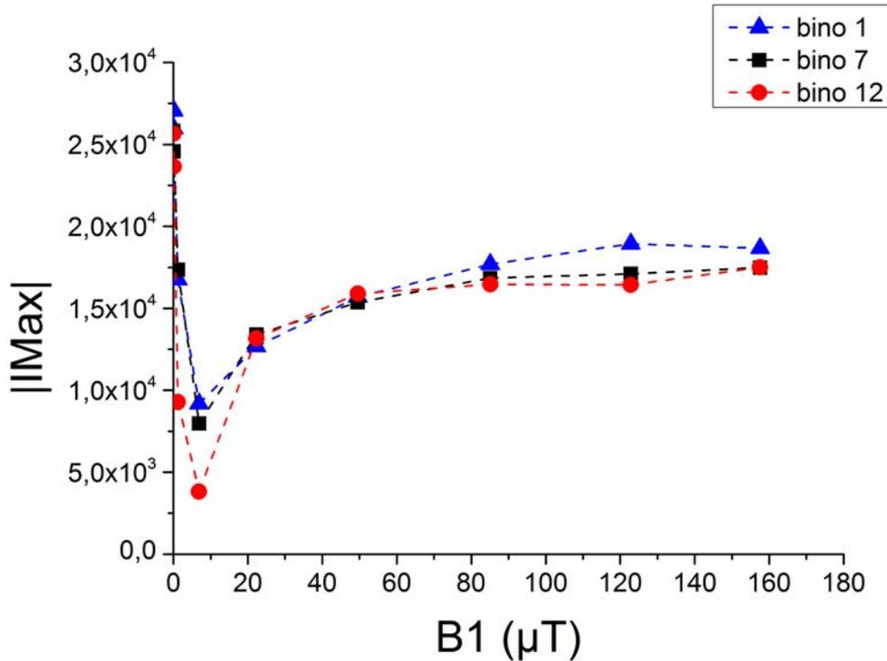
FIGURE 8.6 – **Amplitude de l'écho acquis avec différentes binomiales simples en fonction de l'intensité de la SL.** Comparaison du comportement du signal entre trois formes de binomiales simples différentes : bino 1, 7 et 12, mesuré pour un temps d'évolution de 141 ms avec la séquence MSE spectroscopique, avec strictement les mêmes paramètres d'acquisition sur un échantillon de plastisol 75% standard.
