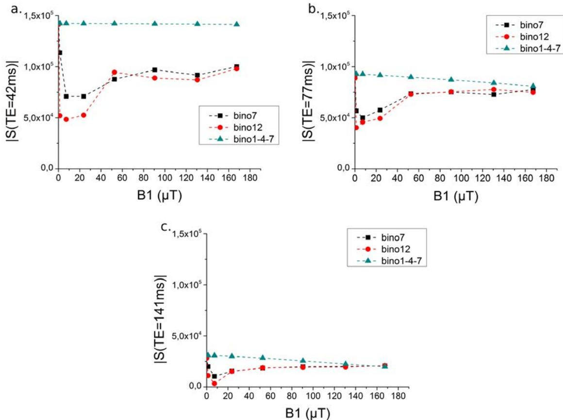
FIGURE 7.5 – Amplitude de l'écho en fonction de l'intensité de la SL pour différentes binomiales. Les acquisitions ont été faites pour différents temps d'évolution ( $6\tau$ ) : 42 ms (a), 77 ms (b) et 141 ms (c), avec une séquence dans l'enchaînement A.
