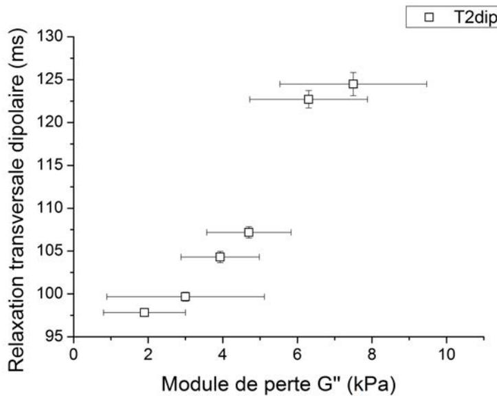
FIGURE 5.9 – Relaxation transversale dipolaire en fonction du module de perte  $G''$ .
