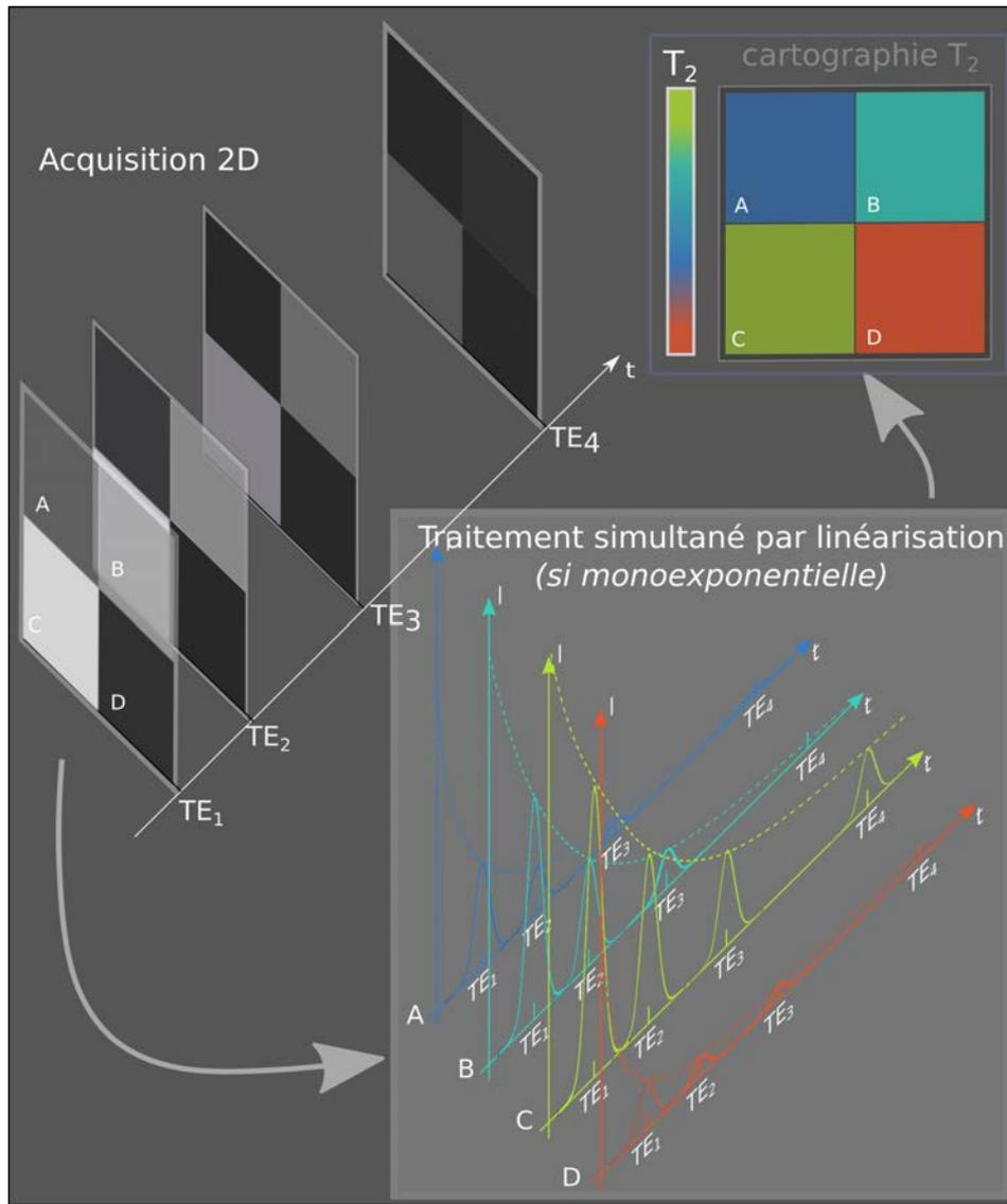
FIGURE 1.14 – Schéma explicatif de l'acquisition en 2D de l'information à différents temps d'évolution pour obtenir une cartographie des valeurs de  $T_2$ .
