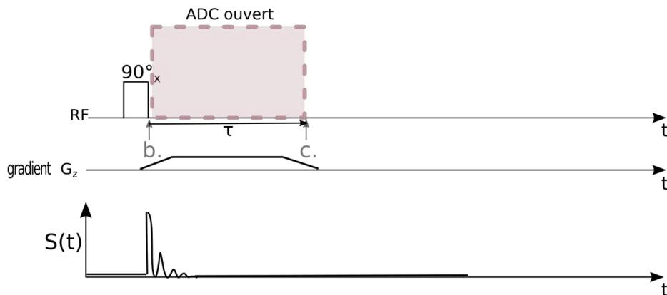
FIGURE 1.6 – **Chronogramme d'une séquence théorique avec une seule RF de  $\frac{\pi}{2}$  avec un gradient de lecture.** Le chronogramme de la séquence est représenté dans la partie supérieure et le signal acquis dans le plan transversal dans la partie inférieure.
