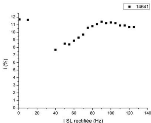
FIGURE 5.11 – **Intensité de l'écho acquis avec la séquence MSE en fonction de l'amplitude de l'impulsion de verrouillage.** L'intensité indiquée en pourcentage est la valeur réelle du signal complexe mesurée sur la console Bruker en mode GSP. Elle indique le pourcentage de remplissage de l'ADC au facteur de préamplification choisi.
