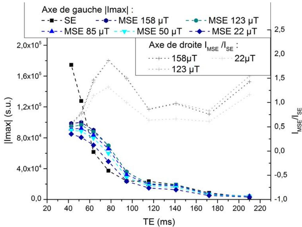
FIGURE 8.5 – **Etude des relaxations de MSE et SE et du rapport existant entre les 2.** Axe de gauche : le comportement du signal acquis avec MSE (avec différentes intensités de SL) et SE est tracé en fonction du temps d'évolution. Axe de droite : le rapport  $\frac{S_{MSE}}{S_{SE}}$  est tracé en fonction du temps d'évolution pour trois amplitudes de SL différentes.
