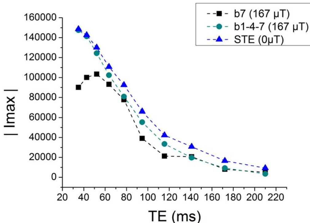
FIGURE 7.6 – **Intensité maximale de l'écho de Hahn en fonction du temps d'évolution ( $6\tau$ )** Les acquisitions ont été faites pour différentes binomiales : bino7 et bino1-4-7 avec une intensité de  $167 \mu T$ , ainsi qu'avec une bino 7 d'intensité nulle (ce qui correspond à une séquence d'écho stimulé), avec une séquence avec un enchaînement de phase A sur du plastisol 75% standard.
