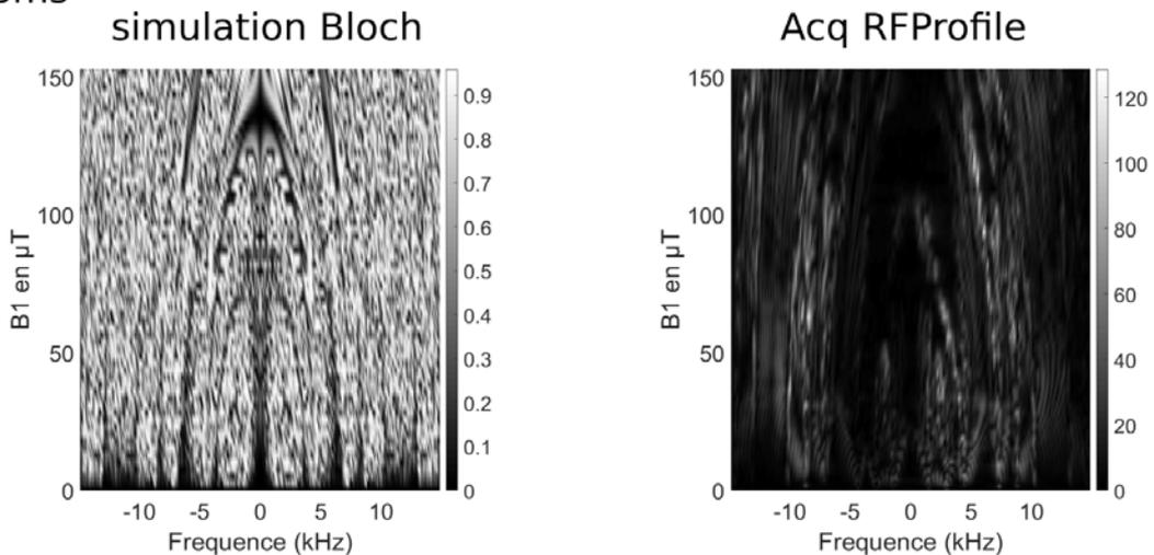
FIGURE 6.7 – Cartographies de déphasage des aimantations sous l'action d'une RF de forme binomiale 4-7. Les résultats expérimentaux (droite) sont présentés en vis-à-vis des résultats simulés (gauche) obtenus dans les mêmes conditions que les conditions expérimentales (système initial suivant  $z$ , observation dans le plan transverse, même durée et même plage fréquentielle de  $B_0$  et même matrice de 256 et 67 valeurs de  $B_1$  entre 0 et  $153 \mu T$ ).
