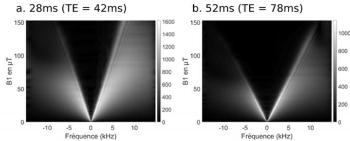
FIGURE 8.9 – **Acquisition avec RF Profile (§ 6.2.2.2) de cartographie de l’effet de l’impulsion binomiale en fonction  $B_0$  et  $B_1$ .** Cartographies acquises avec une bino 1 en fonction de  $B_0$  et  $B_1$ , mesurées pour deux temps d’évolution différents, avec la séquence RFProfile, sur un échantillon d’eau.
