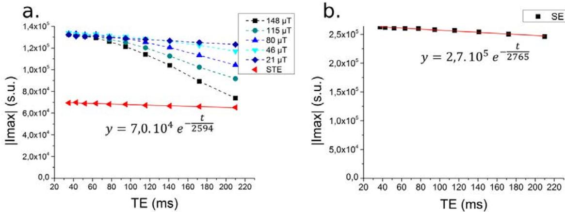
FIGURE 8.4 – **Étude de la relaxation sur l'eau.** A partir des résultats de la décroissance du signal obtenu avec la séquence spectroscopique utilisant une binomiale 1(a) et la CPMG (b) sur le fantôme d'eau, pour différents TE.
