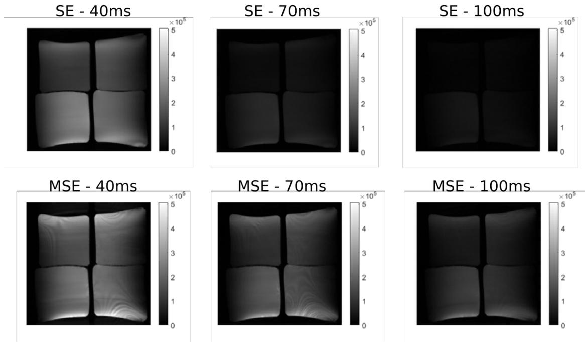
FIGURE 4.19 – Résultats obtenus sur des échantillons de plastisol, pour différents temps d'évolution de  $6\tau$ , avec la séquence de contraste dipolaire du laboratoire. De droite à gauche et de haut en bas, les échantillons sont dans l'ordre les échantillons rigide, 100% standard, 50% standard et 75% standard.
