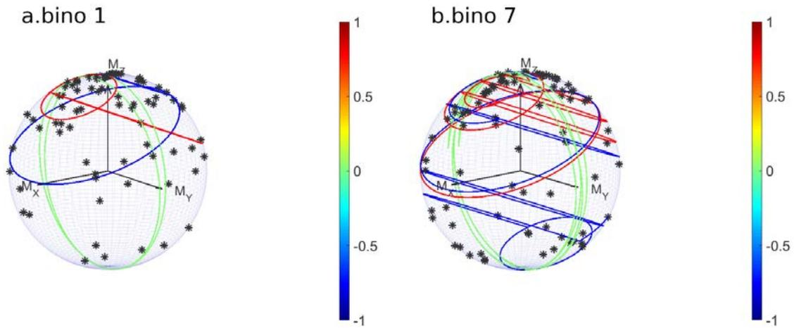
FIGURE 8.8 – **Simulations des trajectoires des aimantations dans la sphère de Bloch.** 3 trajectoires ont été représentées correspondant à des  $\Delta B_0$  positif, négatif et proche de 0. Réalisées à l’aide du logiciel de simulation d’E. Van Reth, pour des binomiales 1 et 7, de durée 3 ms.
