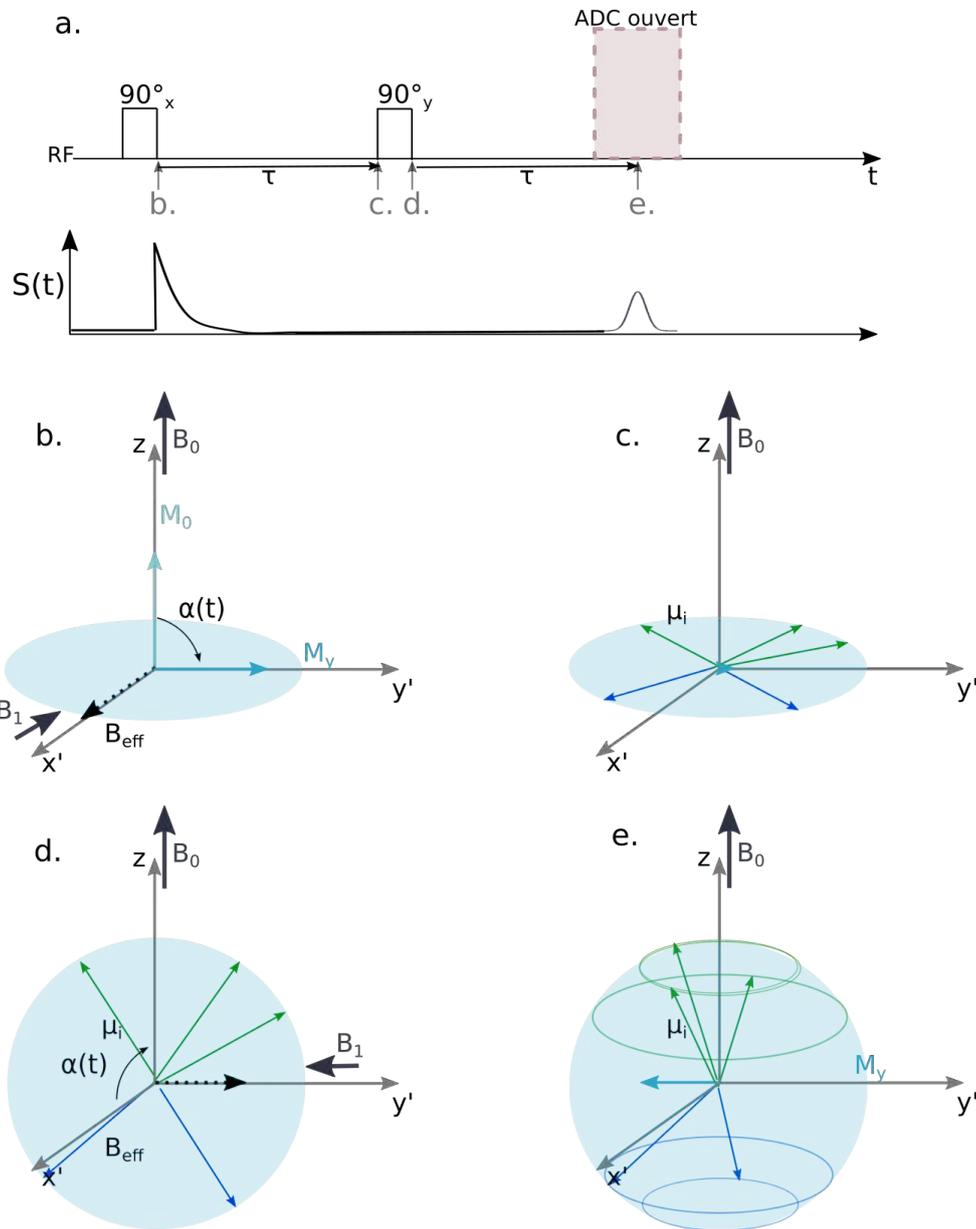
FIGURE 1.7 – **Détail d'une séquence théorique d'écho solide.** Les gradients ne sont pas représentés. a. chronogramme. b.-c. comportement des aimantations similaire au cas de la figure 1.5. d. Les aimantations basculent de  $\frac{\pi}{2}$  rad autour de  $y$  sous l'effet de  $B_1$ . e. Les aimantations microscopiques ont évolué librement pendant  $\tau$ , donc l'aimantation macroscopique dans le plan transverse n'est plus nulle et vaut  $\frac{M_0}{2}$ .
