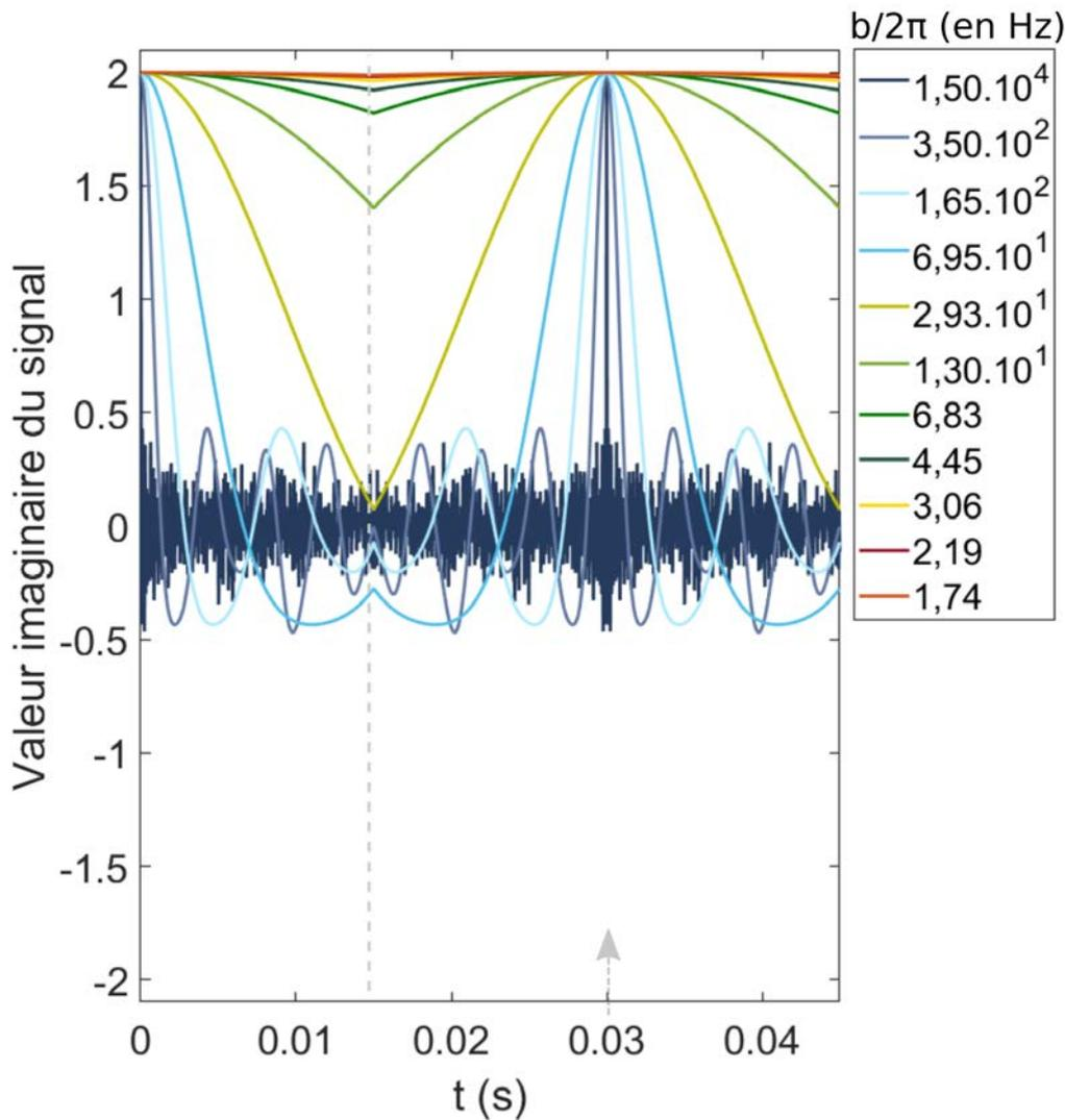
FIGURE 4.4 – Résultats de simulation d’une séquence d’écho solide avec **uniquement l’effet de l’interaction dipolaire**. Le signal tracé sur ces graphiques est mesuré dans le plan transversal pour différentes valeurs de la constante dipolaire  $b$ .
