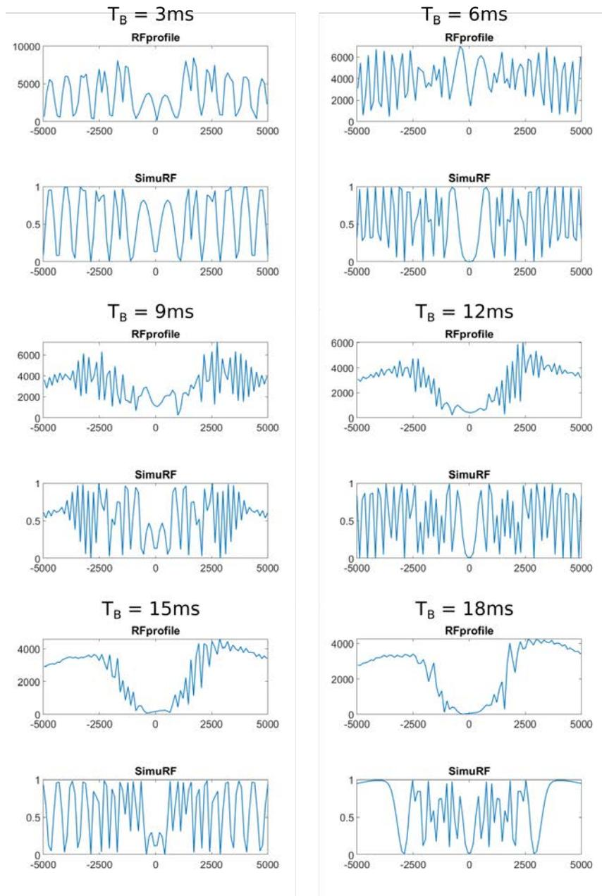
FIGURE 9 – **Etude du comportement des aimantations en simulation et expérimentalement** sous l'action d'une binomiale 1 d'amplitude  $B_1 = 39,42 \mu T$  sur un échantillon d'eau. Les acquisitions pour chaque durée  $T_B$  sont tracées dans l'encadré supérieur et chaque simulation en dessous.
