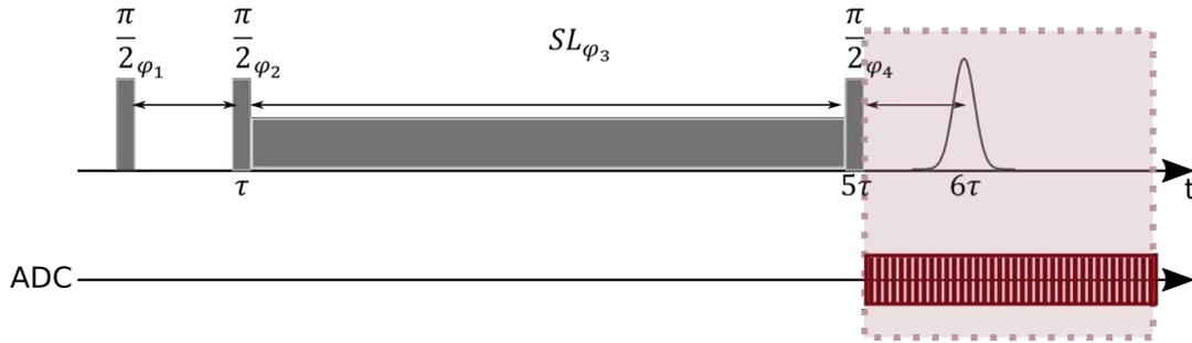
FIGURE 7.1 – **Séquence MSE spectroscopique.** Cette séquence est conçue comme la séquence MSE utilisée en imagerie mais ne contient aucun gradient. L’acquisition débute juste après la dernière RF de  $\frac{\pi}{2}$  et dure pendant 140 ms.
