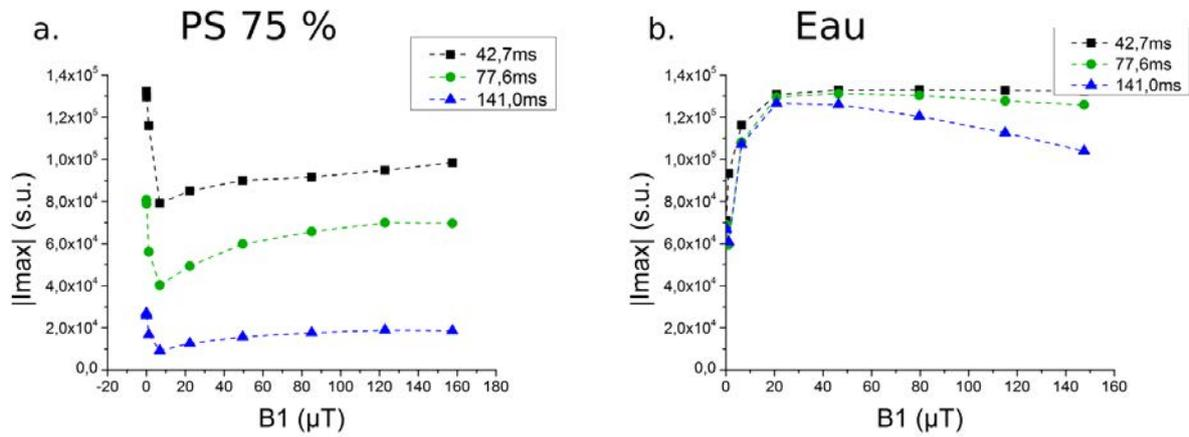
FIGURE 8.2 – **Intensité maximale de l'écho** acquis par la séquence spectroscopique avec des binomiales simples d'intensité différentes sur des fantômes de plastisol 75% standard (a) et d'eau (b), pour différents temps d'évolution.
