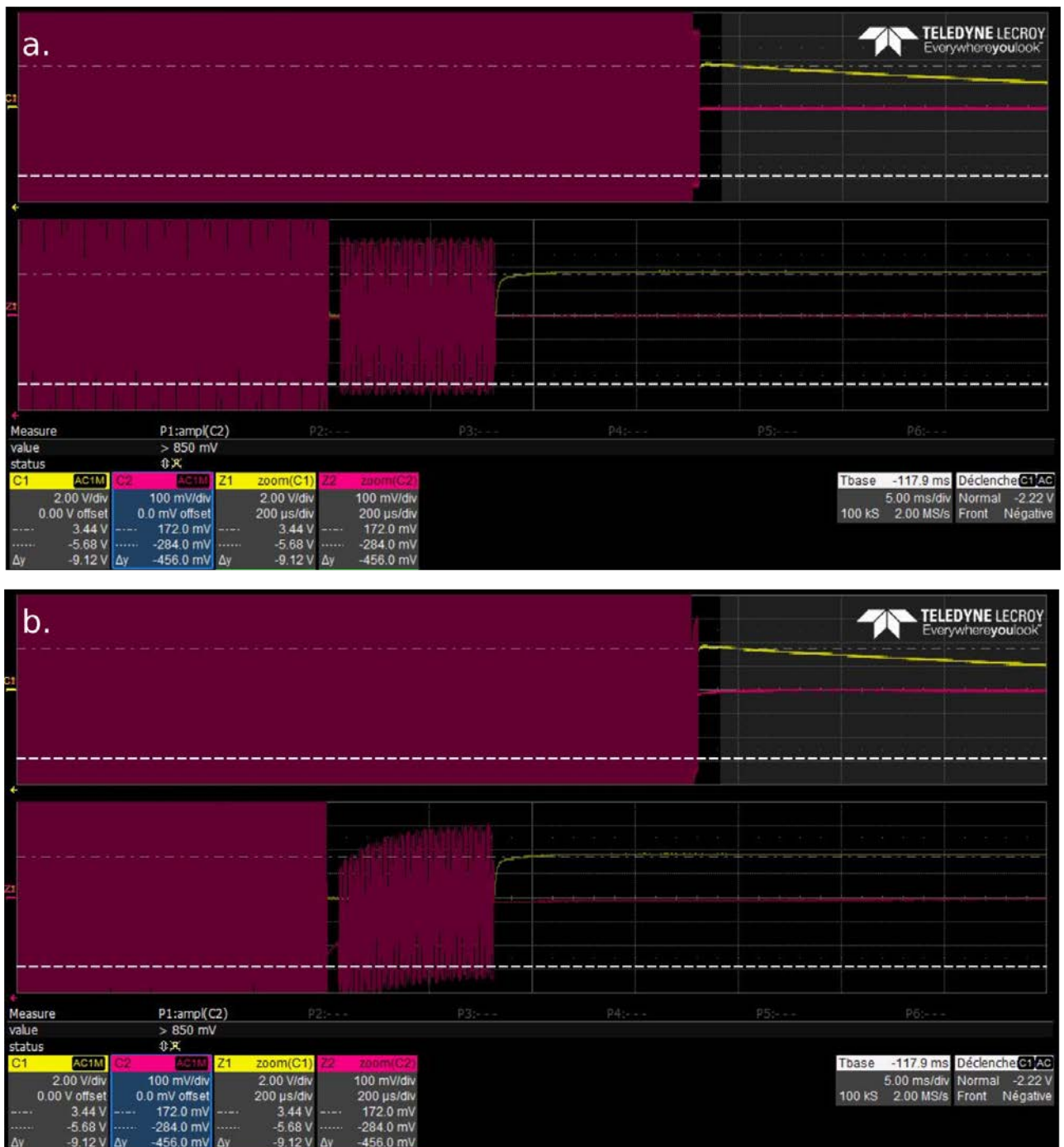
FIGURE 9.3 – Signal réel transmis par l’antenne pour deux intensités de SL différentes ainsi qu’un zoom sur la RF de \frac{\pi}{2} . L’impression d’écran de l’oscilloscope, présente 2 fenêtres. Celle du haut représente le signal acquis sur laquelle une zone non grisée indique sur quelle partie du signal le zoom affiché sur la fenêtre du bas est réalisé. Paramètre de la séquence MSE de spectroscopie : TE = 150 ms , RF de \frac{\pi}{2} : bp, Intensité : 8,77 \mu T ,durée 0,3 ms , RF de saturation : bino1, Intensité : 19,2 \mu T (a) et 48,2 \mu T (b), durée 100 ms.
