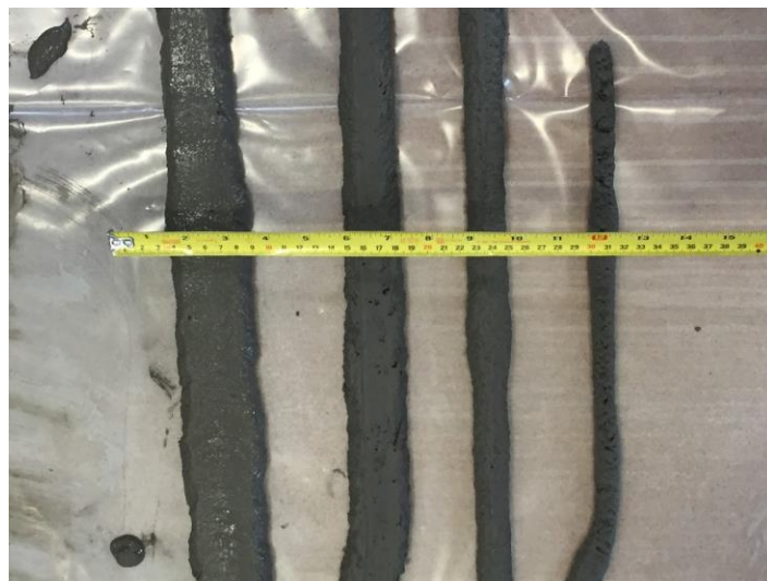
Figure II-17. Détermination de la largeur des cordons
