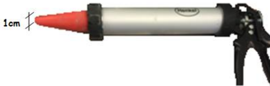
Figure II-2. Pistolet utilisé pour l'impression 3D manuelle
