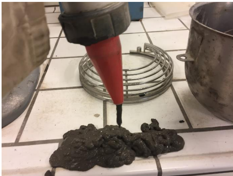
Figure II-4. Exemple d'un matériau trop fluide
