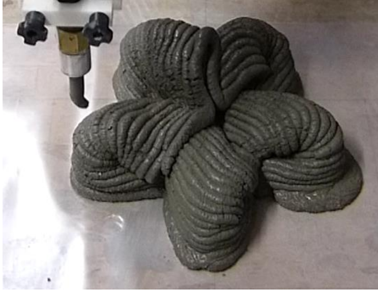
Figure II-18. Défaillance à cause de la non stabilité de la structure
