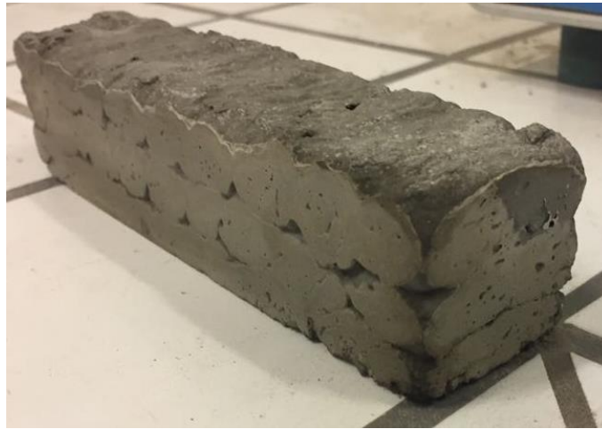
Figure II-7. Développement de spécimens 4x4x16cm imprimés pour les essais mécaniques
