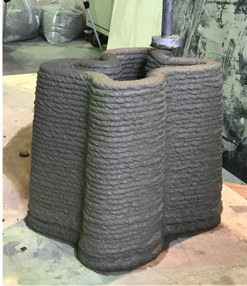
Figure II-20. Amélioration de l'aspect des couches imprimées avec le robot
