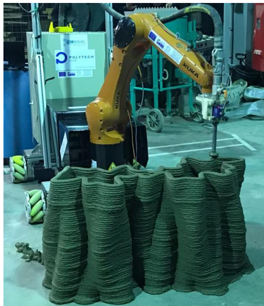
Figure II-21. Robot développé par Polytech Lille pour réaliser des impressions à grande échelle (restitution MATRICE)
