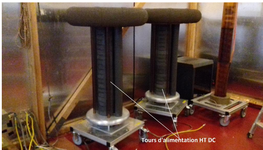
Figure 51 : Photographie des tours d'alimentations HT DC de polarité positive et négative
