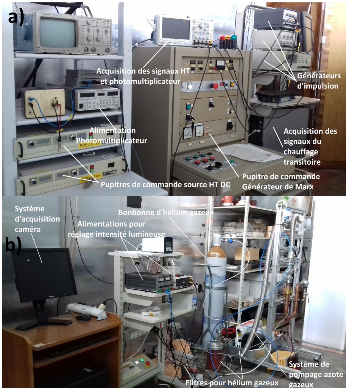
Figure 62 : Aperçu des moyens expérimentaux mis en œuvre (a) Face avant de la cage de Faraday. (b) Face latérale de la cage de Faraday
