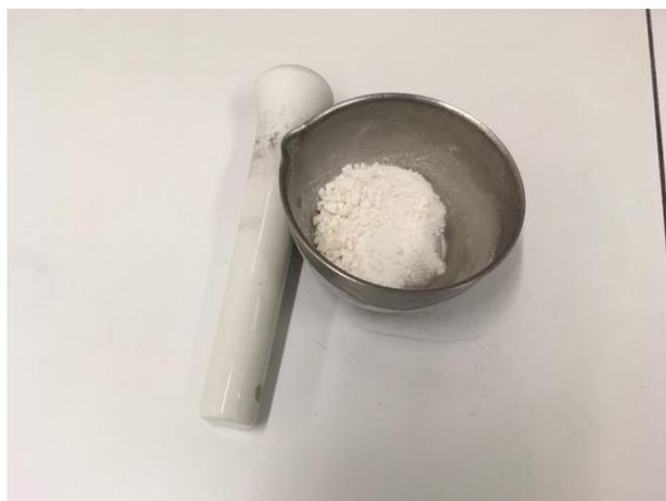
**Figure 23.** Photo du cartilage pulvérisé à l'azote liquide, au pilon et au mortier puis tamisée à 750 $\mu$ m.
