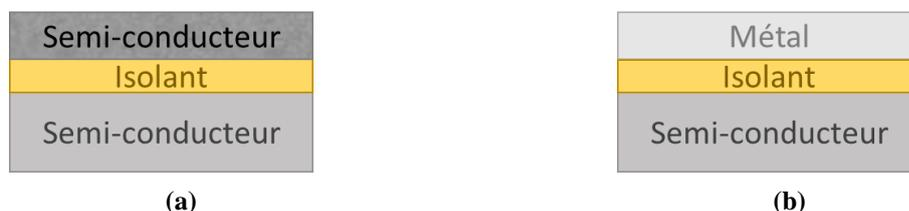
**Figure I- 10 : Représentation schématique des deux voies de contacts passivés envisagées pour la passivation des contacts des cellules solaires silicium : la structure SIS (a) et la structure MIS (b).**
