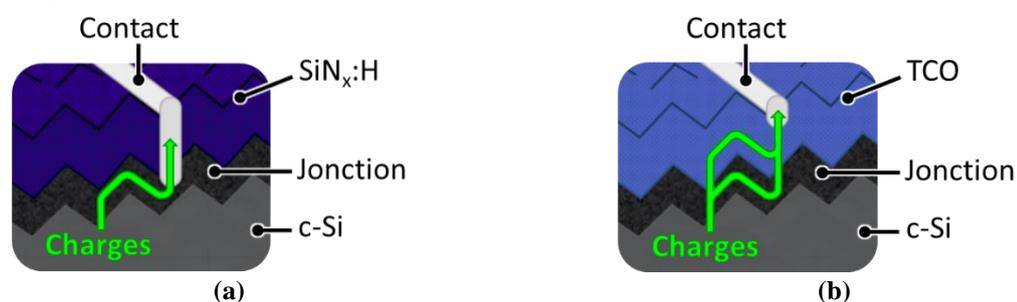
**Figure I- 20 : Schématisation du transport des charges si le contact localisé avec la grille métallique se trouve au niveau de la jonction (a) et si la conduction est assistée par un OTC pleine plaque déposé entre la jonction et la grille de contact.**
