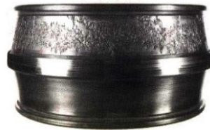
Figure 6. Défaut de roulement – écaillage.
