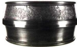
Figure 6. Défaut de roulement – écaillage.
