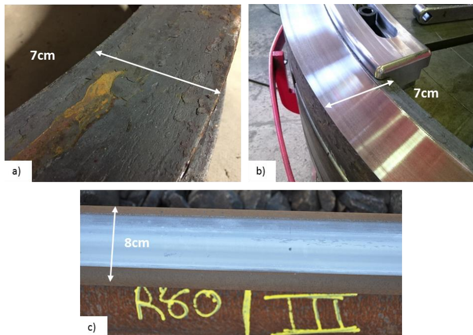
Figure 53 Surface des couronnes a) avant usinage avec la couche de calamine et b) après usinage. c) Rail R260 en voie
