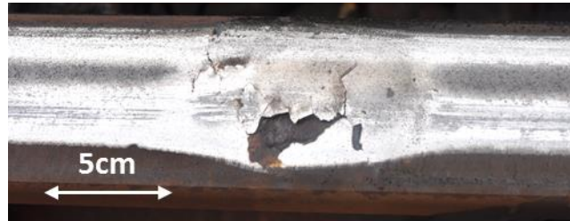
Figure 2 Défaut de Squat sévère observé en voie
