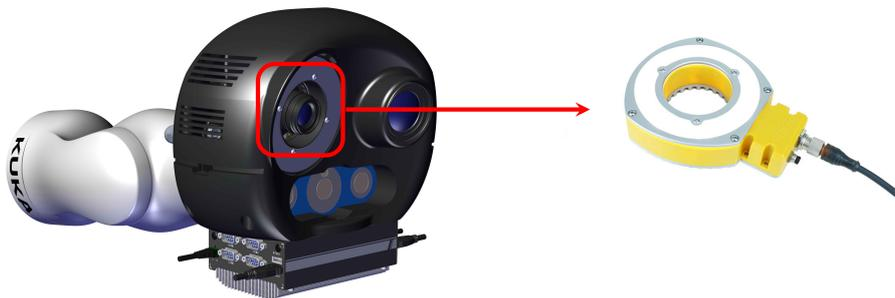
**Figure 3.21** – Système d'éclairage autour de la caméra d'inspection
