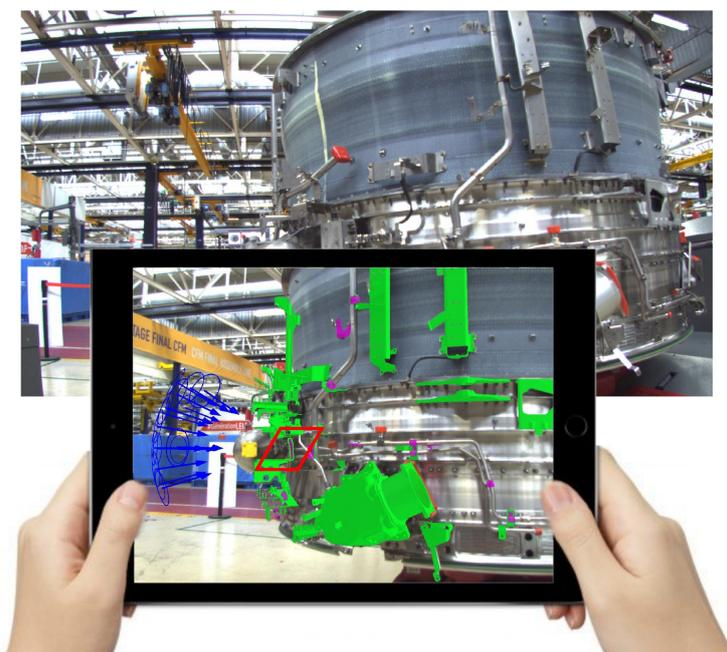
**Figure 2.14** – Guidage de l'utilisateur vers le bon angle de prise de vue à l'aide de réalité augmentée (voir les flèches bleues). L'élément à inspecter est dans le rectangle rouge
