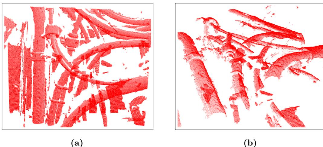
**Figure 4.2** – Nuage de points acquis par le scanner (vu sous 2 angles différents) : la vue de droite montre que les données sont éparées et que l'on ne dispose que d'une faible proportion de la surface du câble cylindrique à segmenter (à peine 1/3 de la circonférence)
