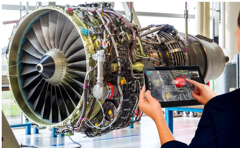
**Figure 1.2** – Inspection via une tablette, équipée d’une caméra, portée par un opérateur
