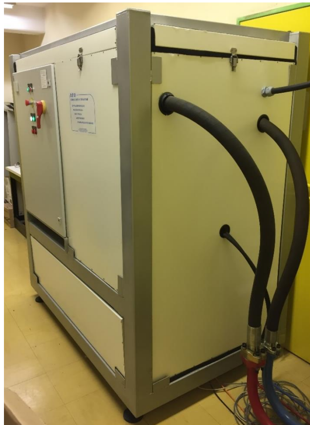
Figure 4.24 : Centrale hydraulique du banc d'essais au laboratoire FEMTO-ST
