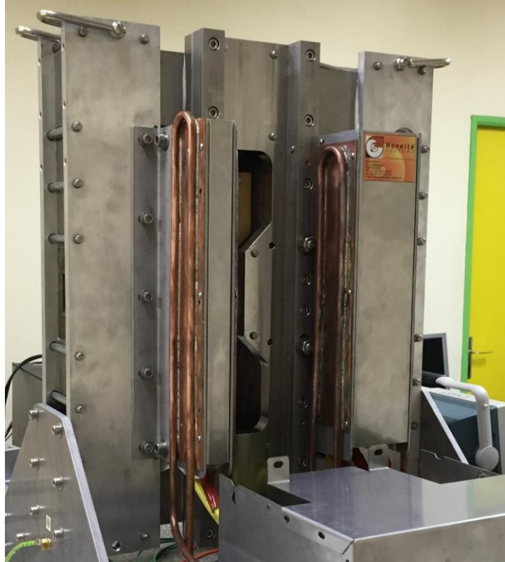
Figure 4.19 : Système hydraulique pour la dissipation des échauffements
