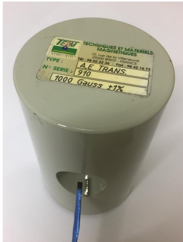
Figure 4.37 : Aimant pour l'étalonnage d'une sonde à effet Hall
