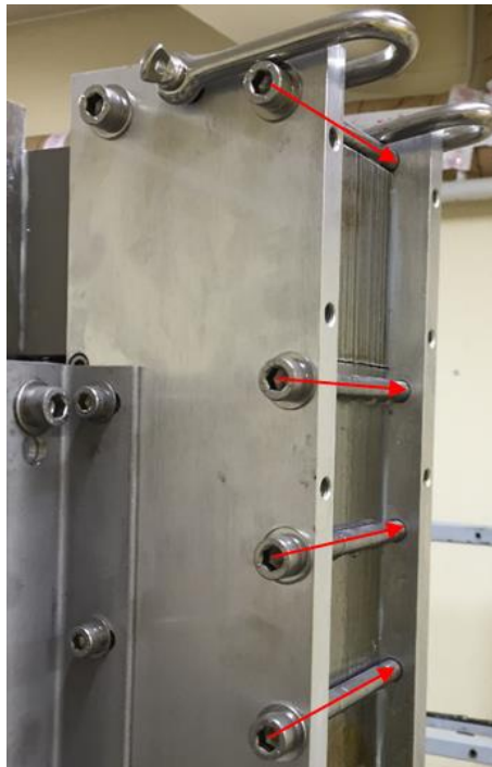
Figure 4.15 : Vis traversantes créant des inductances de fuite
