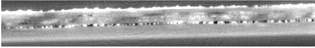
Figure 4.2 – Image par tomographie d'un assemblages co-cuit [0_4] -colle- [0_5] direction Y (parallèle aux fibres)
