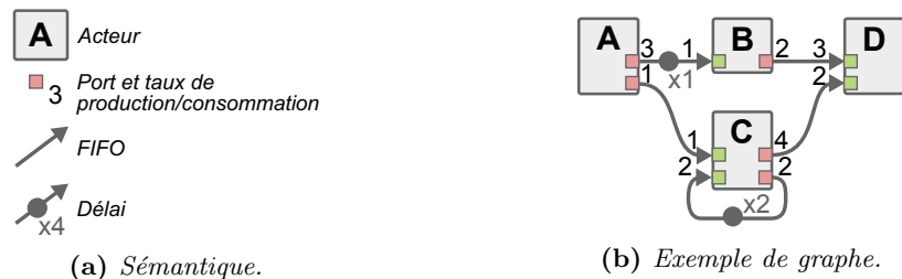
FIGURE A.1 – Modèles de calcul SDF .
