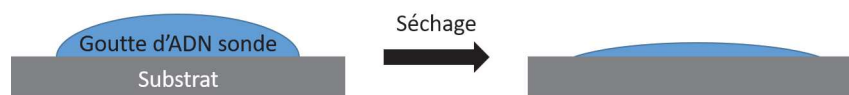
FIGURE V.14: Représentation schématique du séchage de la goutte d'ADN sonde par surface constante.
