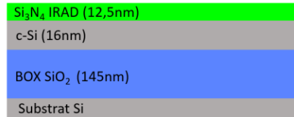
Figure II-21. Empilement des plaques SOI avec dépôt de nitrure IRAD.
