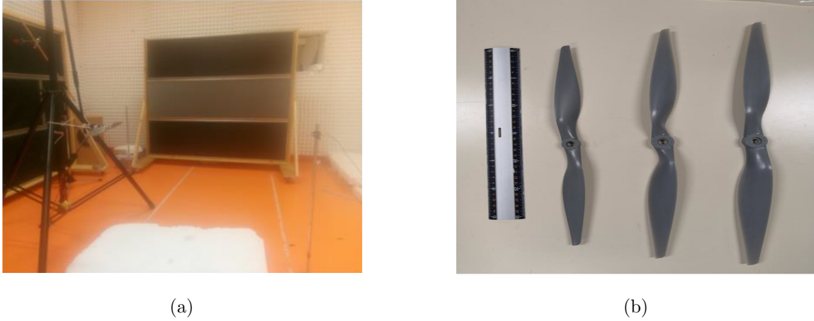
FIGURE 3.5 – (a) Photo du système de mesure pour la caractérisation acoustique des hélices et (b) photo des hélices à caractériser à côté d'un double décimètre. De gauche à droite : hélices 14 \times 8.5 , 16 \times 10 et 17 \times 8 .
