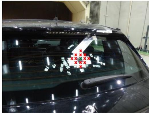
FIG. 4.34 – Photographie de l'antenne de 13 accéléromètres espacés de  $\Delta = 3$  cm appliquée sur la lunette arrière.
