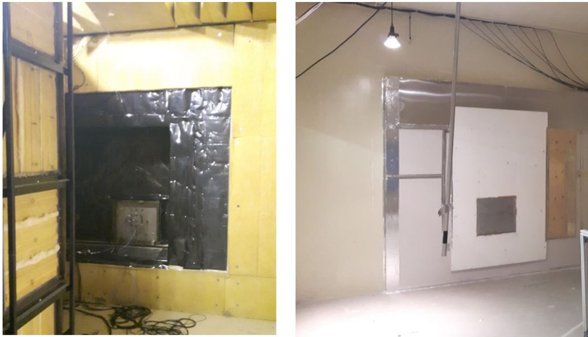
FIG. 4.2 – Photographies du dispositif expérimental : (a) vue de la face arrière de la plaque munie d’une antenne de 13 accéléromètres dont le point central correspond au point de reconstruction de la pression pariétale. (b) Vue de la face avant de la plaque située en chambre réverbérante et excitée par une source acoustique.
