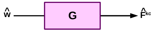
FIG. 2.3 – Schéma bloc du principe d'obtention de la distribution de force reconstruite dans une gamme de nombres d'onde à partir du déplacement.
