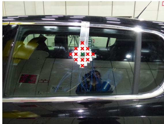
FIG. 4.29 – Photographie de l'antenne de 13 accéléromètres espacés de \Delta = 3 cm appliquée sur la vitre passager arrière gauche.
