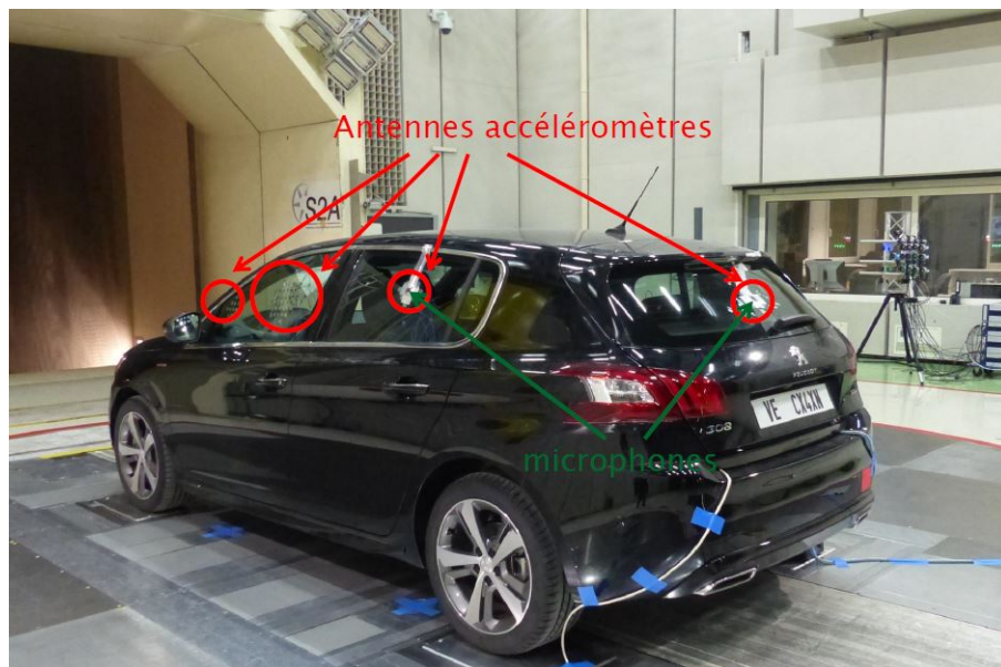
FIG. 4.14 – Photographie de la Peugeot 308 instrumentée par des antennes accélémétriques sur les faces internes des vitrages et par des microphones affleurant sur les faces externes.
