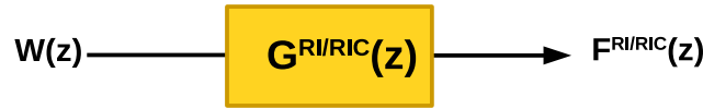
FIG. 2.12 – Fonction de transfert représentant le filtrage apporté par les méthodes inverses RI et RIC.
