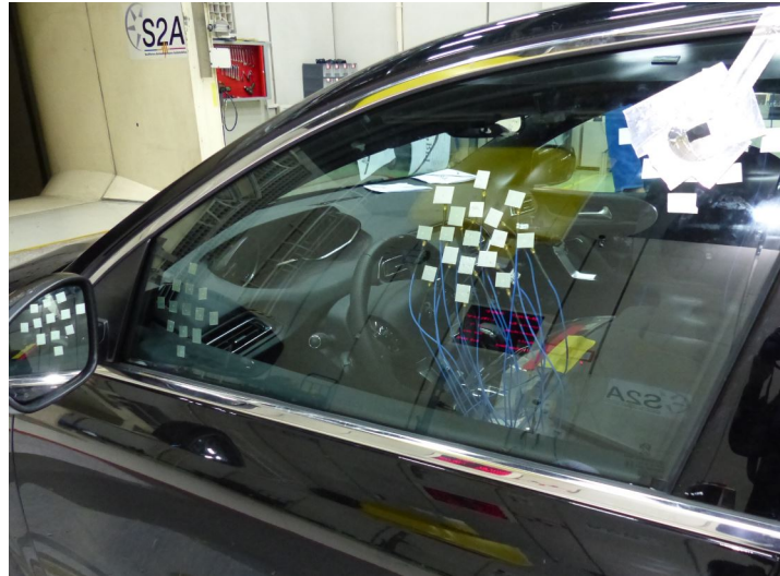
FIG. 4.40 – Photographie de l'antenne polaire contenant 17 accéléromètres espacés de \Delta = 3 cm appliquée sur la vitre conducteur.
