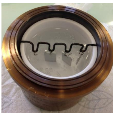
Figure 2.5 : Intérieur d'un autoclave de 0,16L avec les échantillons sur le porte-échantillon immergés dans la solution
