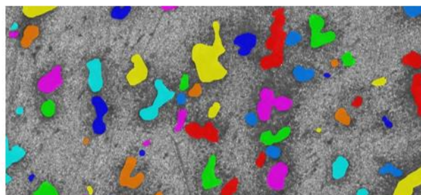
Figure 2.10 : Illustration de la méthode pour le calcul de la densité surfacique et de la surface occupée par les amas : a) micrographie au Microscope Optique de la surface d'un échantillon corrodé; b) la même micrographie une fois traitée
