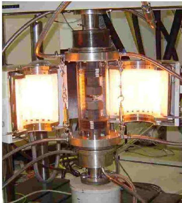
Figure II.3 : Four de chauffage intégré à la machine de torsion utilisé pour la déformation des échantillons (Laboratoire SMS, Ecole des Mines de Saint–Etienne).
