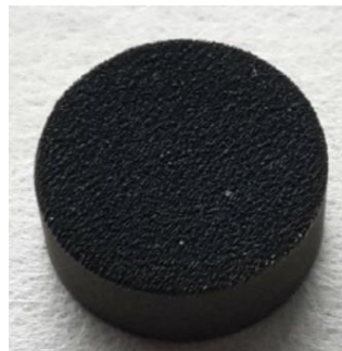
Figure 211 : Photographie de la pastille d'Inconel 718 texturée
