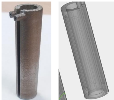
Figure 203 : Manchon refroidi avec circulation interne d'eau
