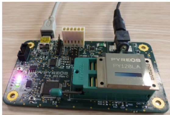
Figure 204 : Barrette pyroélectrique PYREOS® en fonctionnement
