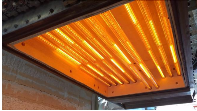
Figure 4 : Exemple de plateau de chauffage pour un formage SPF-IR[3]
