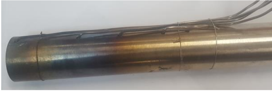
Figure 145 : Barreau en inox 310 instrumenté
