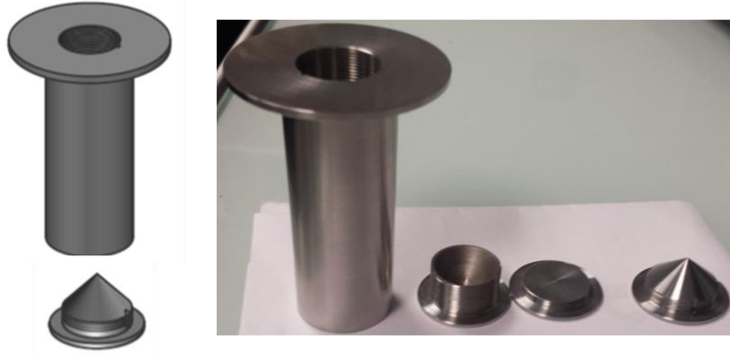
Figure 37 : Corps noir de transfert cavité avec les différents fonds possibles
