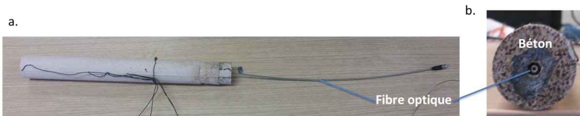
Figure 146 : Barreau de béton instrumenté ; a. Vue de côté ; b. Vue de face
