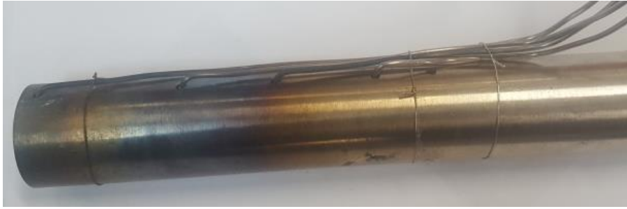
Figure 145 : Barreau en inox 310 instrumenté
