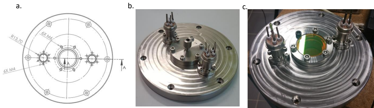
Figure 32 : a. CAO du couvercle instrumenté pour les mesures sous vide, b. Configuration NIR avec passage fibre optique, c. Configuration MIR avec hublot ZnSe
