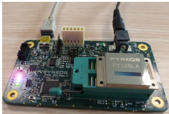
Figure 204 : Barrette pyroélectrique PYREOS® en fonctionnement
