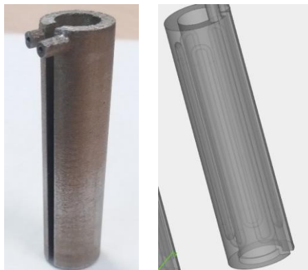
Figure 203 : Manchon refroidi avec circulation interne d'eau
